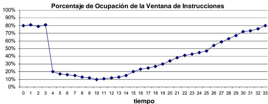
**Figura 1.2.** Efecto de un fallo de predicción en la ocupación de la ventana de instrucciones del núcleo de ejecución. La gráfica se ha obtenido de una ejecución real.
