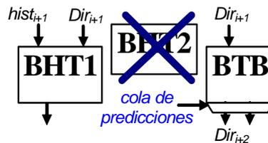
**Figura 3.18.** La información de la cola de predicciones se usa para sustituir a las etapas vacías de *BHT*.
