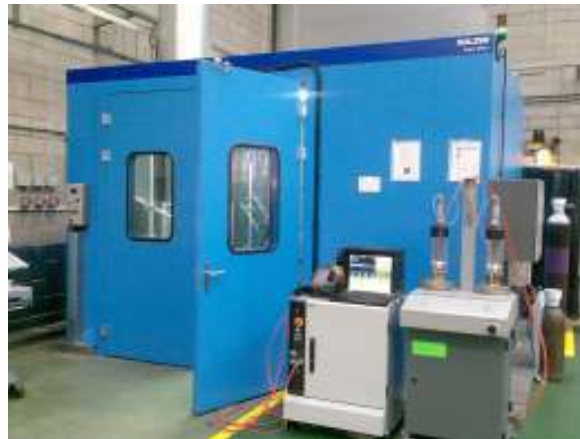
Fig.3.3: Cabina de proyección térmica HVOF insonorizada.
