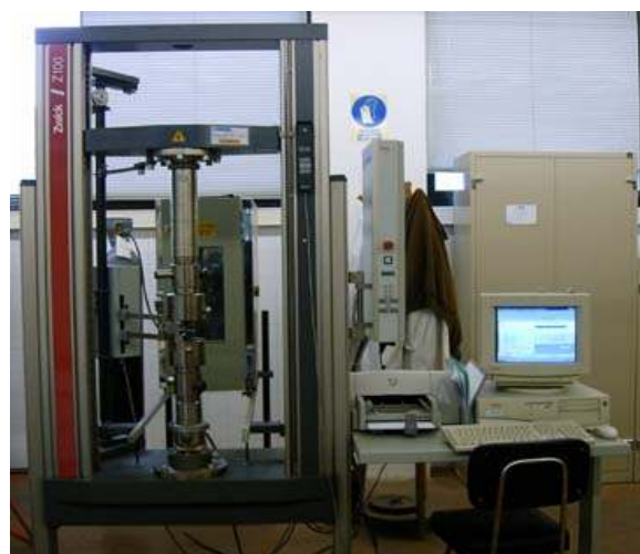
Fig.4.25: Máquina de tracción ZWICK Z10- TL3S utilizada para los ensayos de adherencia.
