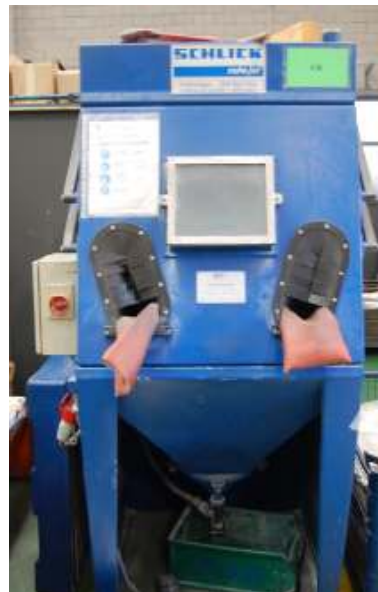
Fig.3.18: Granalladora modelo SCHLIEK, utilizada para el granallado de pre-tensión.
