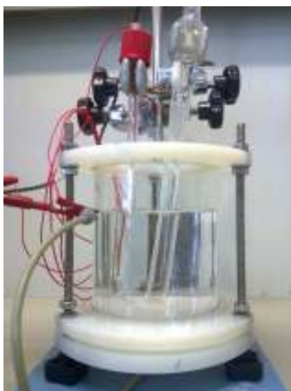
Fig.4.42: Celda de corrosión tipo "TAHITI" y disposición de los electrodos de referencia.
