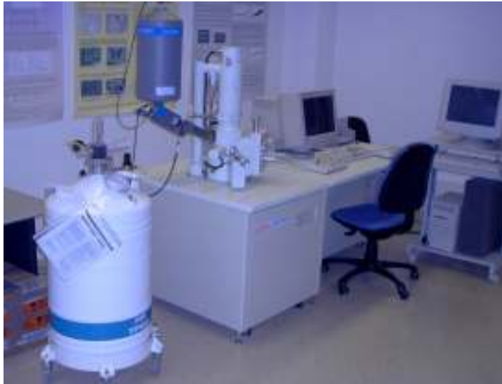
Fig.4.16: Microscopio electrónico de barrido SEM modelo JEOL-5600.
