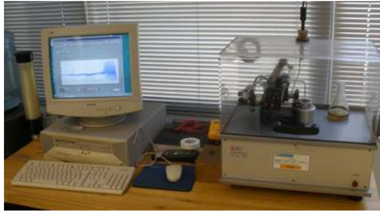
Fig.4.30: Tribómetro Pin-on-Disk CSEM utilizado para la evaluación de evaluar el desgaste.
