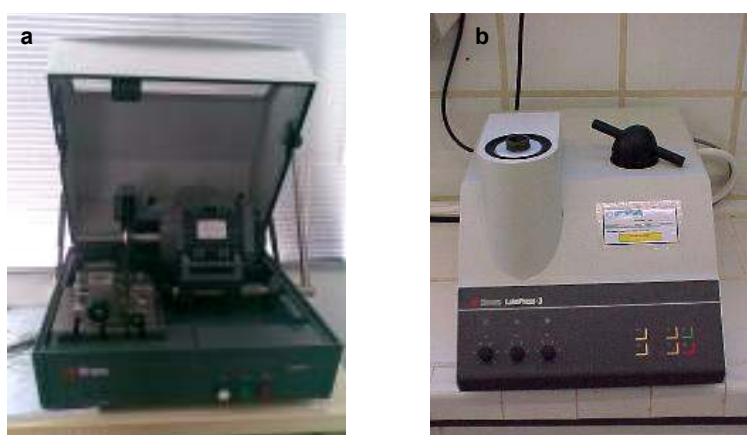
Fig.4.12: Equipos de corte y encastado de muestras metalográficas: tronzadora manual de disco “Struers Labotom 3” (a) y prensa metalográfica “Labopress 3” (b).
