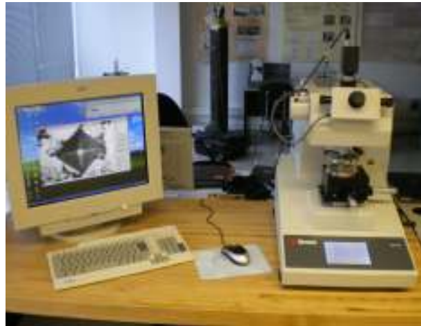
Fig.4.20: Microdurómetro STRUERS Pedemin-5 utilizado para la determinación de durezas.
