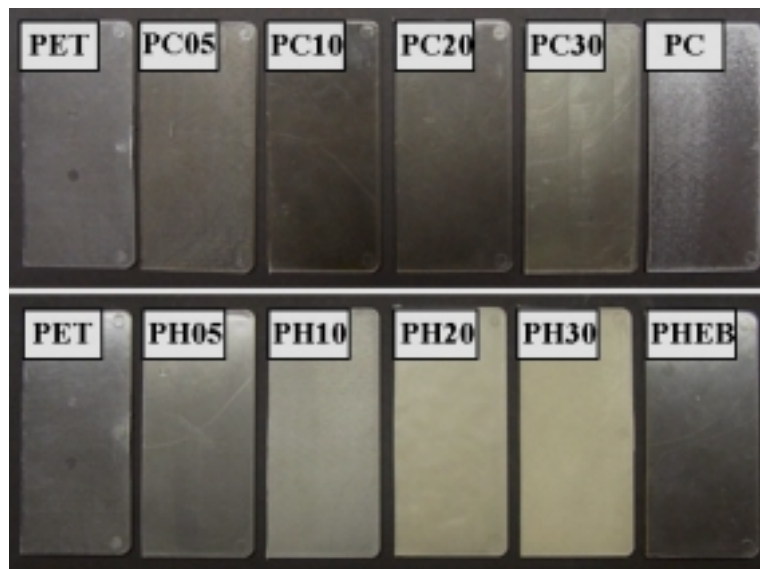
Figura 5.1.2: Muestras de las placas inyectadas del PET-1 y de las mezclas preparadas con éste.
