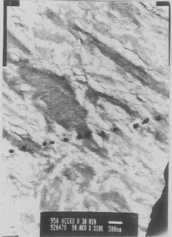
Figura 4.5.b. Acero A, austenizado a 950°C durante 30 minutos.
