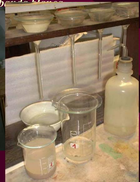
*-Para finalizar el análisis los 250ml de los líquidos de lavado de la recuperación con sosa se dejan evaporar a 170°C en un disco de porcelana con capacidad para 400ml.*
