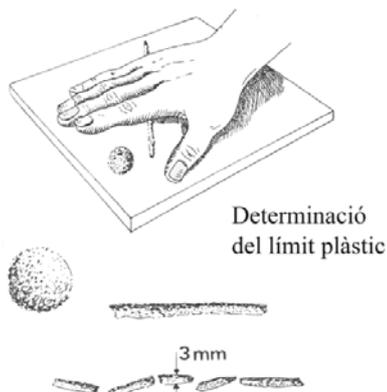
La porción así obtenida se coloca en un pesafiltros tarado, y se continúa el proceso hasta reunir unos 5 gr de suelo. Se determina la humedad de acuerdo con la norma [UNE-328](#). Se repite el proceso con la otra mitad de la masa. El límite plástico es la media de las humedades de ambas determinaciones. Se expresa como porcentaje de humedad, con una cifra decimal.
