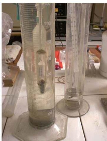
Fig 1 Termómetro, densímetro y probetas utilizadas para el ensayo.
