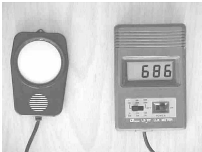
Figura B.4 Luxómetro digital utilizado.
