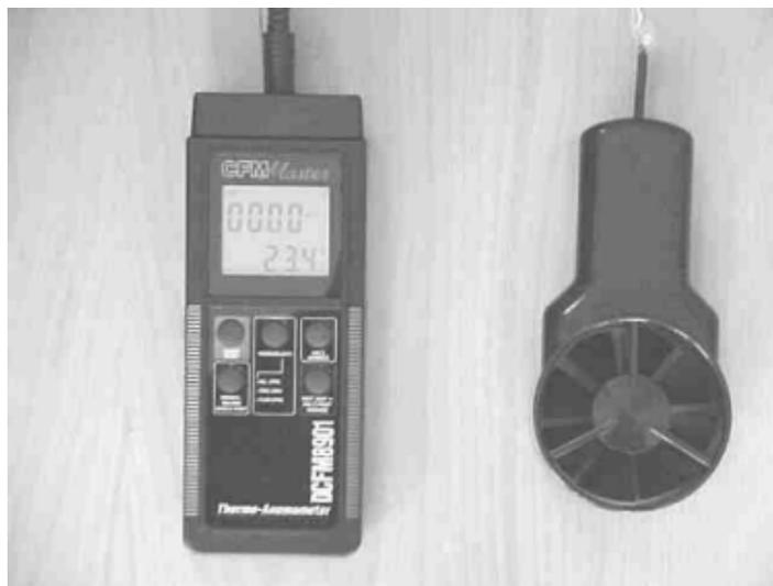
Figura B.5 Imagen del Termoanemómetro.
