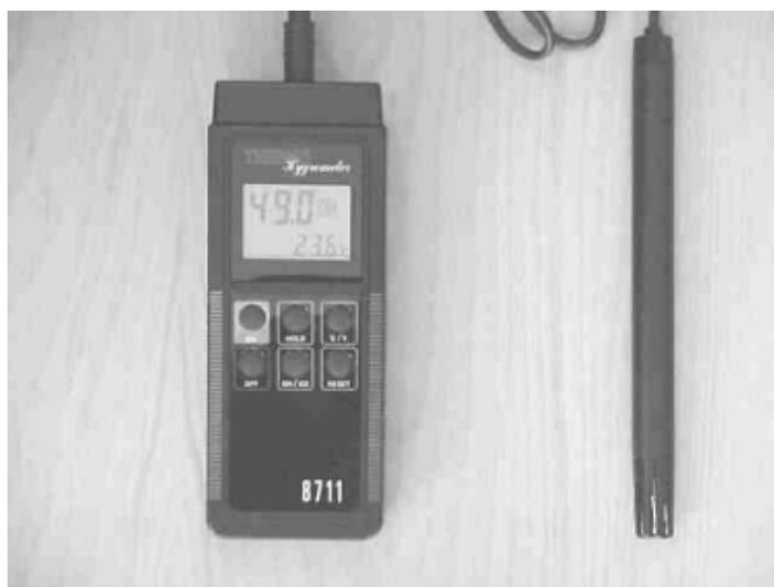
Figura B.3 Termohigrómetro digital empleado en las mediciones.
