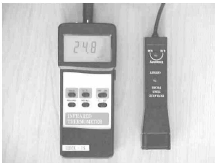
Figura B.5 Imagen del termómetro a infrarrojos.
