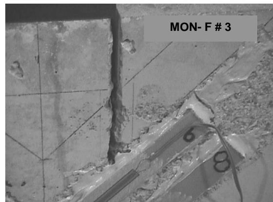
Fig. A29 Esta foto es un acercamiento del lado "B" donde se muestra el desprendimiento a todo lo largo de la lámina 6
