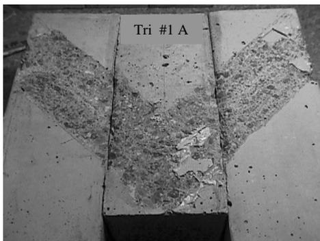
Fig. A37 Las laminas del lado "A" trabajaron más eficientemente ya que fue una cantidad menor de resina la que quedó adherida sobre la probeta.
