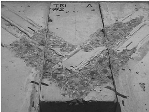
Fig. A42 En esta foto se puede observar la resina que quedo adherida a la superficie del hormigón en el bloque central, muy probablemente debido a un pequeño momento torsor como se muestra en la foto de la figura A35
