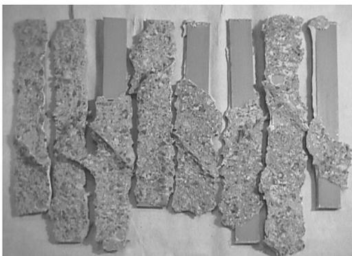
Fig. A49 Esta foto muestra las láminas de aramida desprendidas del hormigón durante el ensayo, en las cuales se puede valorar la eficiencia de adherencia del compuesto Resina-Fibra a la superficie de hormigón en función de la cantidad de hormigón que fue desgarrado o desprendido bajo la acción de los esfuerzos cortantes en la probeta.
