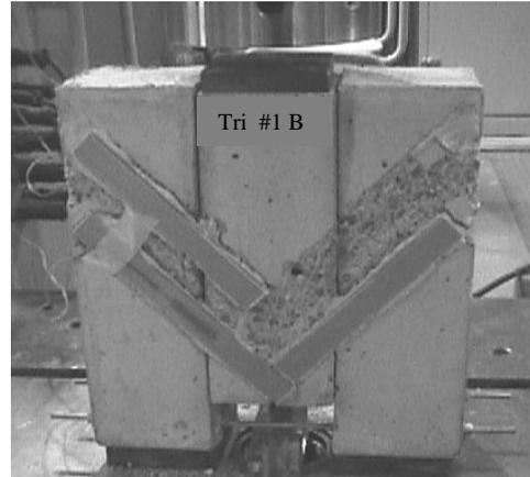
Fig. A36 Esta foto muestra el lado "B" de la probeta ya ensayada, en la cual se desprendió la lámina 2 totalmente y las tres láminas restantes se desprendieron de los bloques laterales a causa principal de esfuerzos perpendiculares a la superficie.
