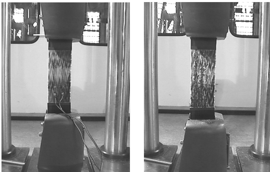
Figura 4.48. Ensayo de caracterización del sistema de refuerzo TFC: (Izq.) Inicio del ensayo; (Der) Rotura.
