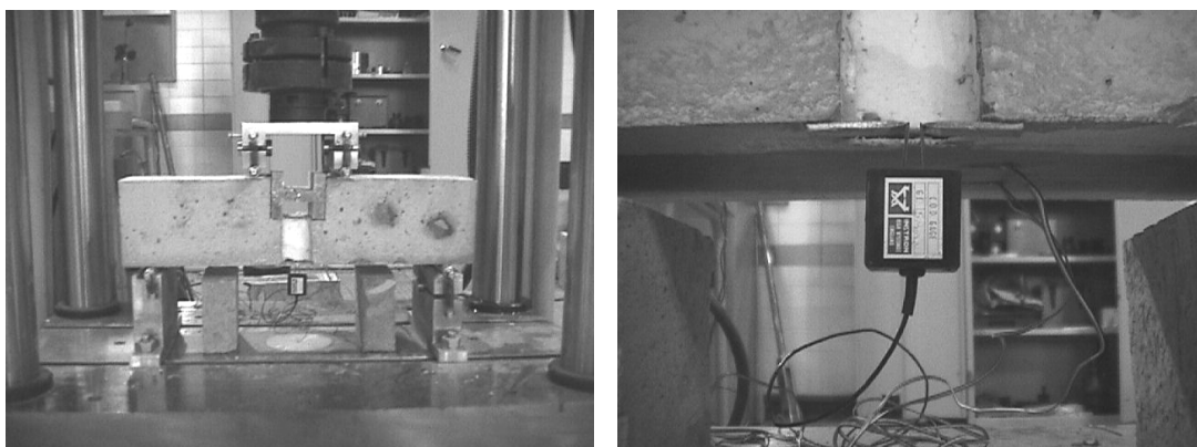
Figura 4.36. Ensayos de adherencia serie 1; (Izq.) Vista global del ensayo; (Der.) Detalle del clip en la zona central inferior de la probeta.
