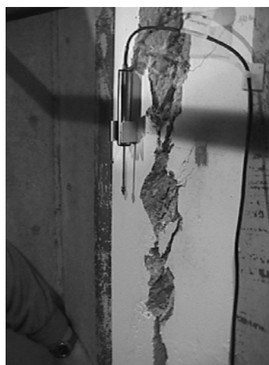
Figura 4.23. PC-JC. Estado en el que quedó la junta tras la rotura.
