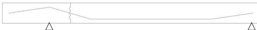
Figura 6.14. Modelización de los ensayos V3, realizada con una única junta y dos dovelas.
