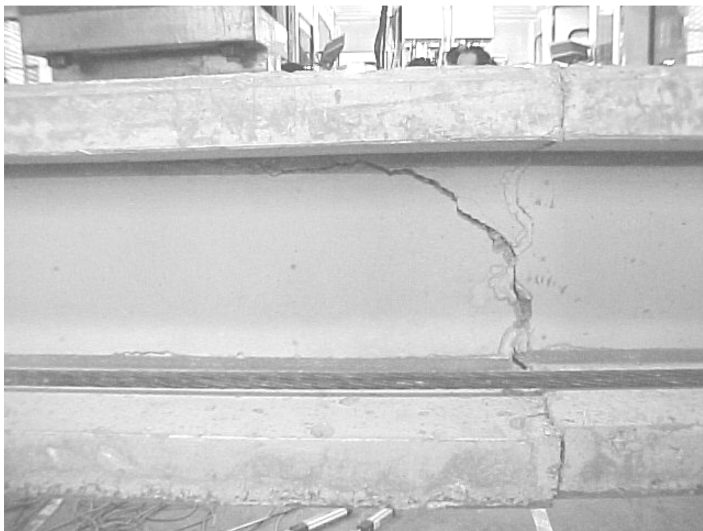
Figura 4.48. Ensayo V1-SFRC-35. Fase de prerrotura
