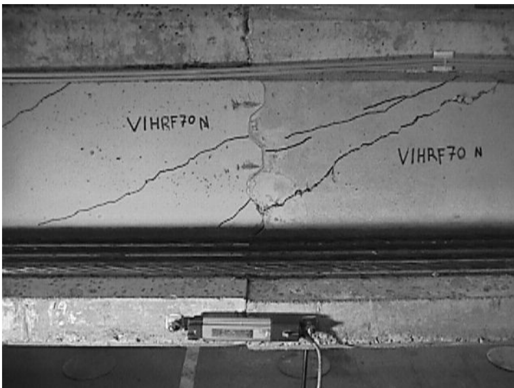
Figura 4.49. Ensayo V1-SFRC-70. Fase de prerrotura (a) y viga descargada (b).
