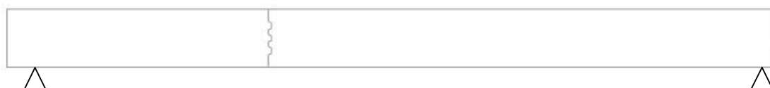
Figura 6.2. Modelización de los ensayos V1, realizada con una única junta y dos dovelas.
