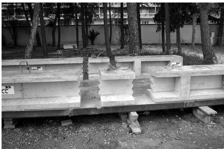
Figura 4.34. Dovelas vigas UPC.
