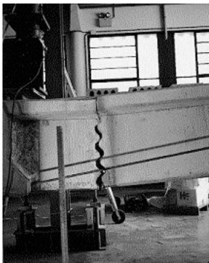
Figura 3.4. Junta abierta en fase de prerrotura. LTE-UPC
