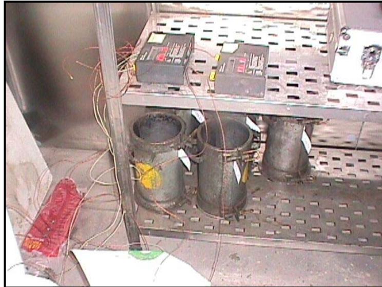
Figura 3.5.- Disposición de los dispositivos para el registro de temperatura en probetas
