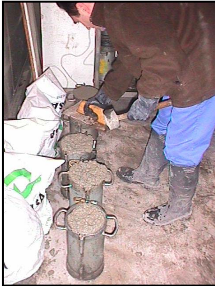
Figura 4.5.- Elaboración de probetas
