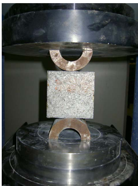
Figura 3.8: Método para partir en dos mitades las probetas de hormigón
