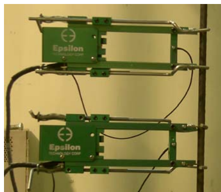
Figura 4.10: Disposición de los “Epsilon” en la probeta
