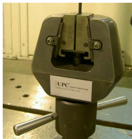
Figura 4.9: Mordaza con garras intercambiables
