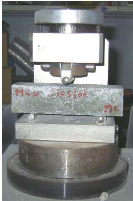
Figura 3.9: Método para partir las probetas de mortero
