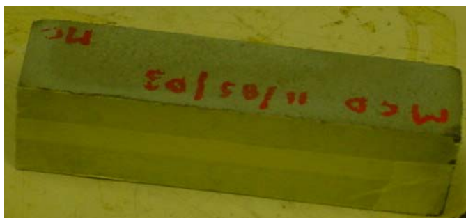
Figura 3.3: Probetas prismáticas de mortero de inyección
