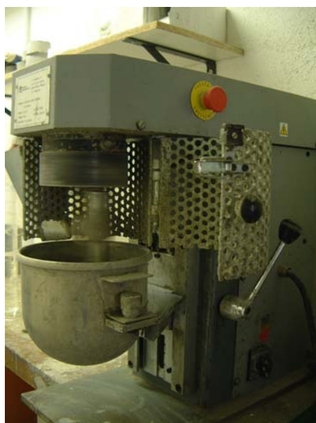
Figura 3.4: Amasado de la mezcla para las probetas de mortero
