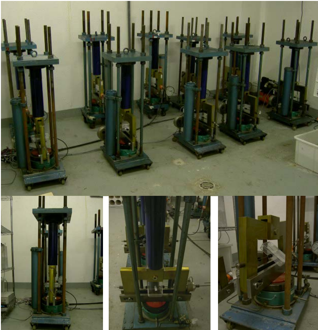
Figura 5.13: Montaje del marco con los alambres en los bastidores
