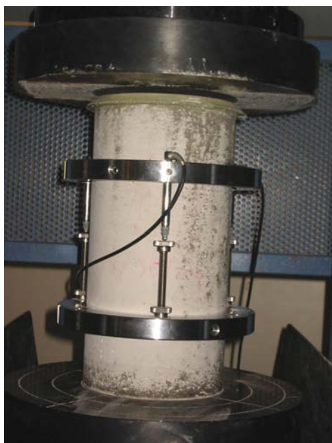
Figura 3.2: Ensayo para obtener el módulo de elasticidad
