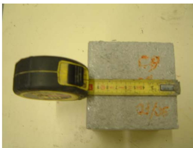
Figura 3.1: Probetas cúbicas de hormigón
