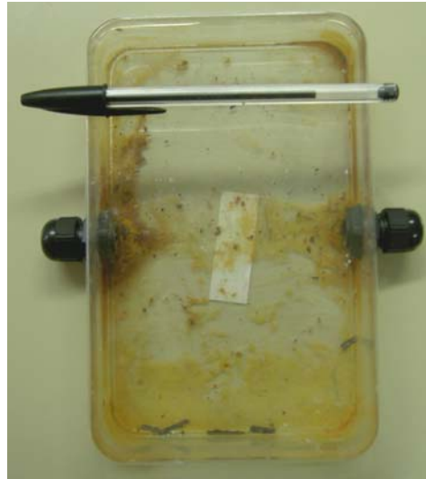
Figura 5.2: Caja plástica utilizada como cámara de ataque
