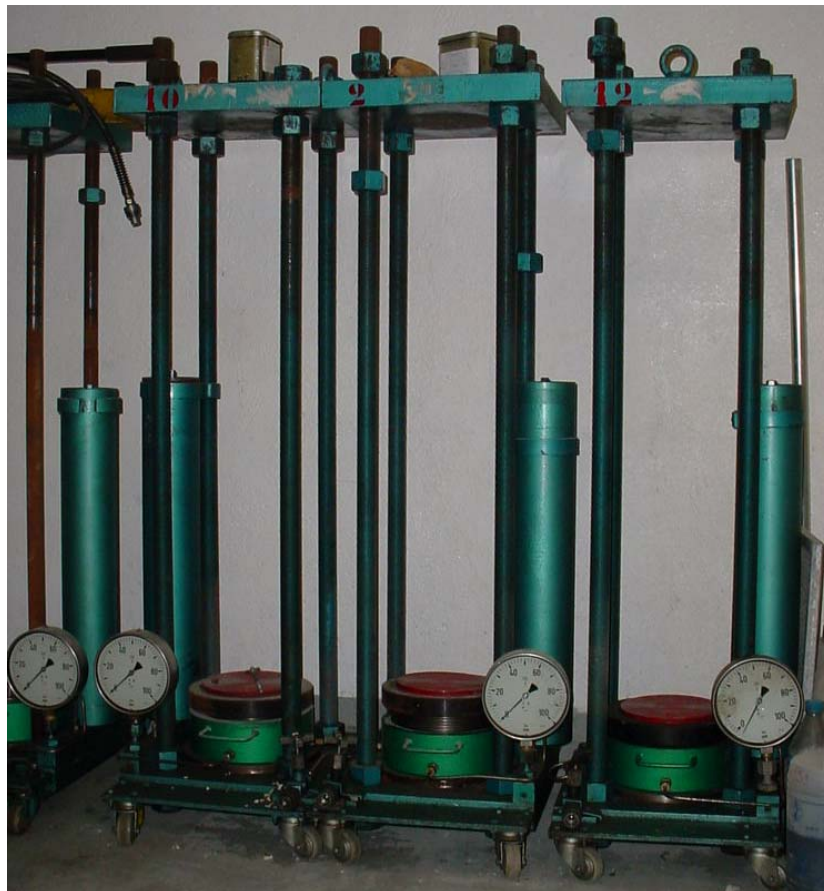
Figura 5.6: Bastidores de fluencia para hormigón
