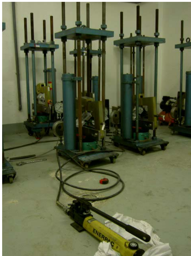
Figura 5.12: Puesta en carga de los bastidores
