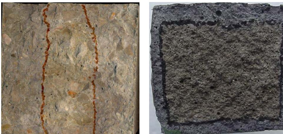
Figura 3.10: Probetas con nitrato de plata (Colorimetría)
