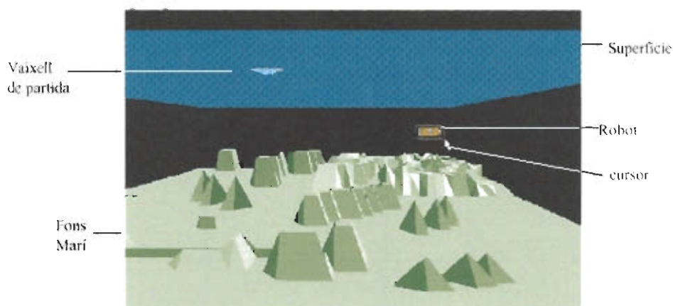
Fig. 4.21.- Interfície Virtual per a la conducció de vehicles submarins teleoperats
