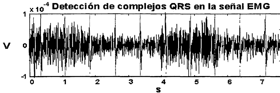
Figura 5.31: Instantes detectados de los complejos QRS en la señal EMG real correspondiente a dos ciclos respiratorios registrada a un paciente con una carga del 75% MCS.
