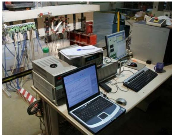
**Figura 4.21. Sistema de adquisición de datos HBM MGC Plus**
