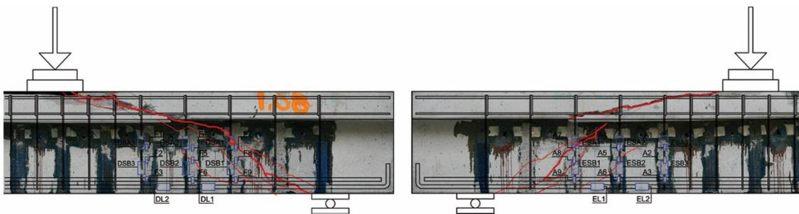
**Figura 5.26. Fisuras producidas en el ensayo M1B**
