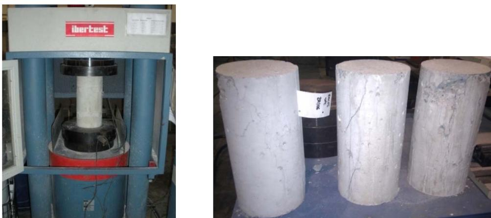
Figura 4.8. Ensayo a compresión simple de probetas de hormigón y probetas después del ensayo
