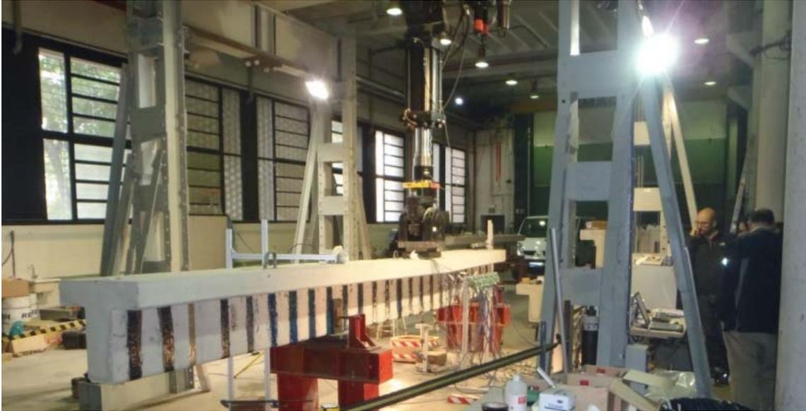
**Figura 4.18. Pórtico de carga con actuador hidráulico MTS.**
