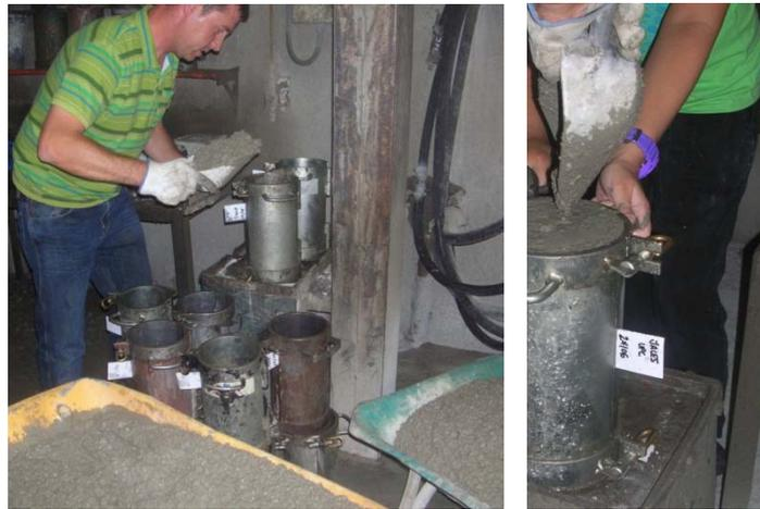
Figura 4.6. Ejecución de las probetas de hormigón para cada una de las cinco amasadas
