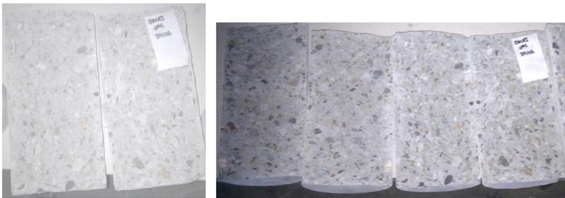
Figura 4.10. Probetas ensayadas a tracción indirecta mediante el ensayo brasileño
