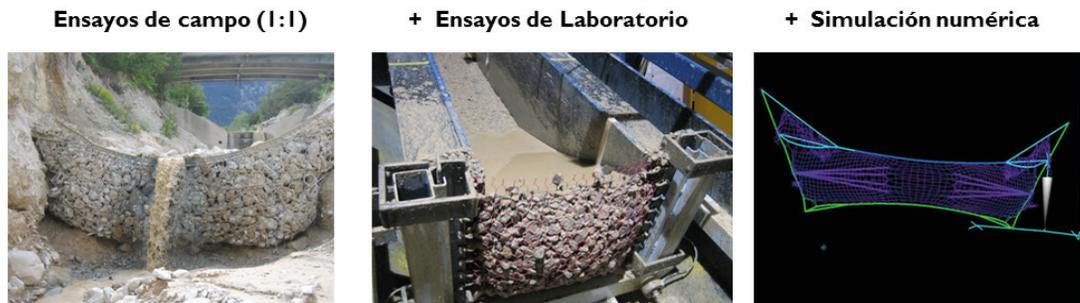
Figura 3.19: Muestra del orden de investigación y trabajo para alcanzar la optimización del producto VX. (Fuente: Geobruigg).
