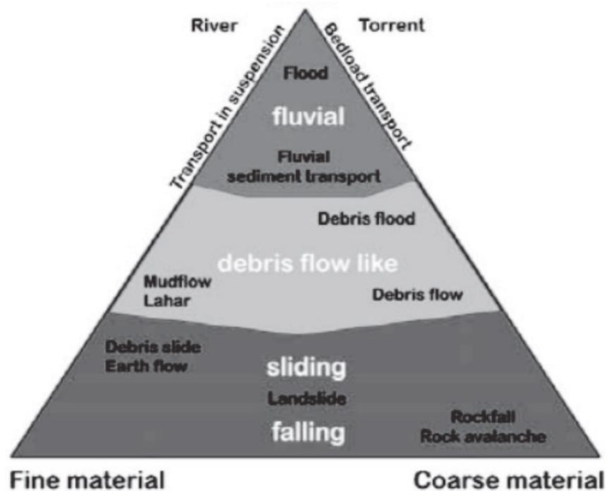
Figura 1.5: Diagrama triangular de los diferentes tipos de movimientos en masa a partir del porcentaje de las partículas constituyentes (Phillips and Davies, 1991), (ONR-24-800, 2007).
