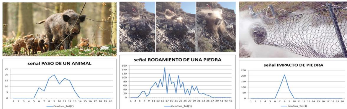
Figura 4.2: Representación en términos de intensidad (impulso/segundo) en el eje vertical y duración en el tiempo (segundos) en el eje horizontal de distintas señales registradas por un único geófono. (Imagen izquierda procedente de: <http://www.remediando.com/2011/04/jabali-el-cerdo-salvaje.html>; imágenes derecha procedentes de [www.geobrug.com](http://www.geobrug.com))
