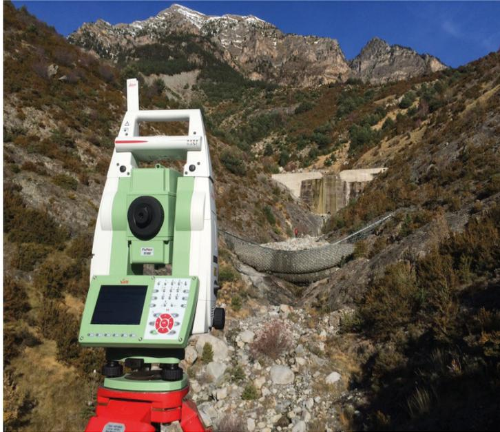
Figura 4.9: Detalle del levantamiento topográfico a partir de estación total para medir los volúmenes de los distintos eventos.
