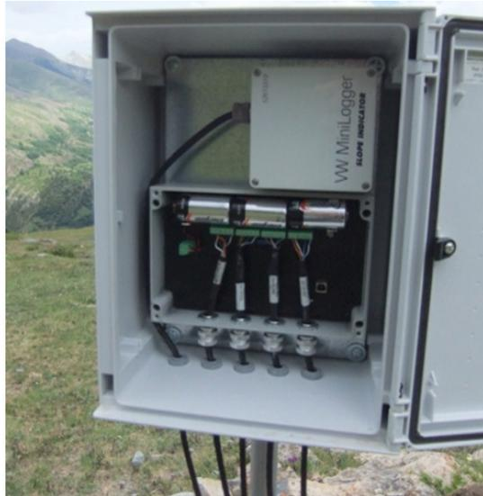
Figura 3.10: Imagen de la estación de control de los piezómetros y esquema de la interface del software de conexión. (Fuente: Propia)
