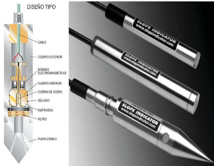
Figura 3.6: Despiece de un piezómetro de cuerda vibrante e imagen de los piezómetros proporcionados por Slope Indicator para este trabajo (Fuente: Slope Indicator).
