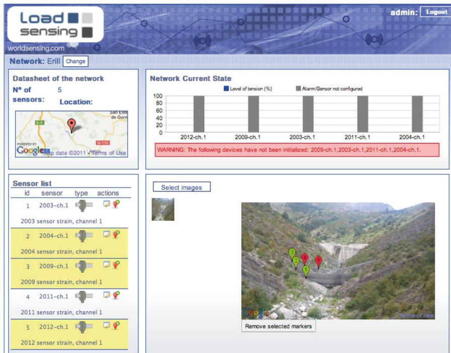
Figura 3.31: Pantalla de control del sistema de recolección de datos inalámbrico instalado en la malla. (Fuente: Propia).
