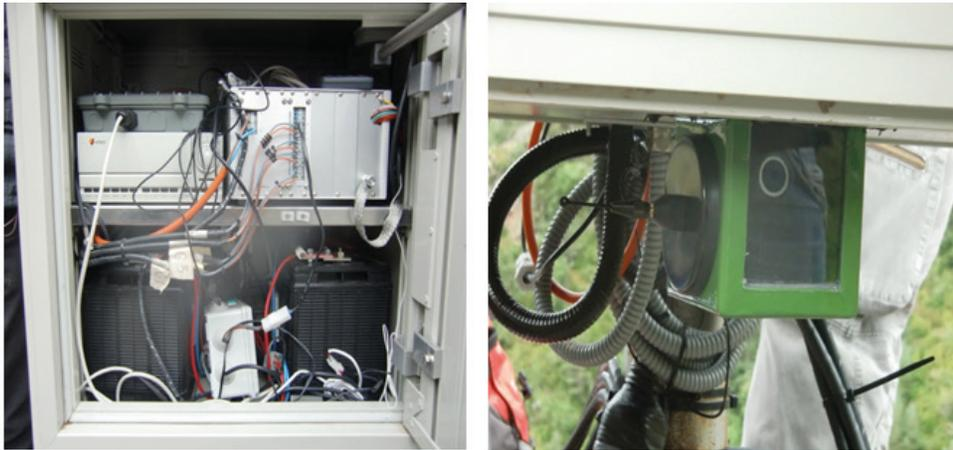
Figura 3.12: a) Imagen general de la central de adquisición de datos, fuente de alimentación foco y cámara; b) imagen de detalle del interior de un geófono instalado en Eril; c) datalogger, modem, grabadora y baterías; d) webcam y antena. (Fuente: Propia)
