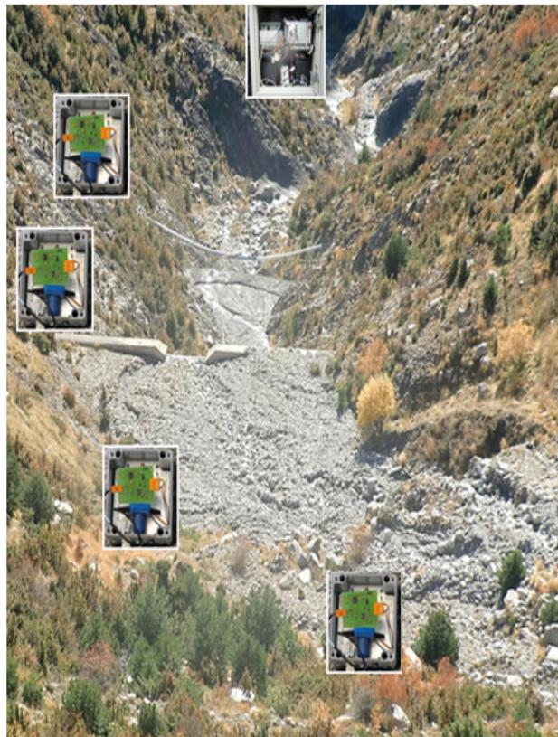
Figura 3.15: Vista general del tramo auscultado del Barranco de Erill donde se observa la ubicación de cada geófono. (Fuente: Propia).
