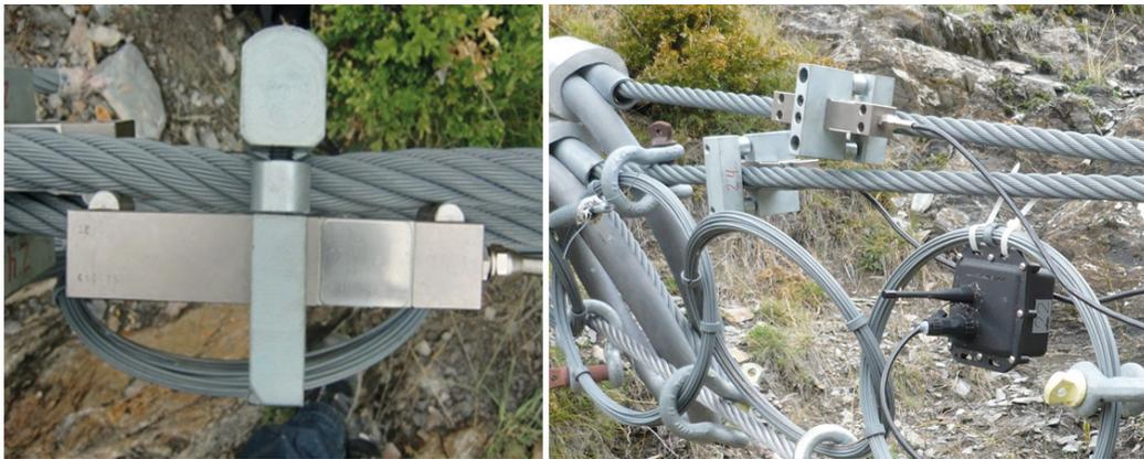
Figura 3.27: Sensor de carga (fuente: ADI ARTECH TRANSDUCERS y sensor inalámbrico) (caja negra) conectado a un transductor de carga axial en la malla. (Fuente: Propia).
