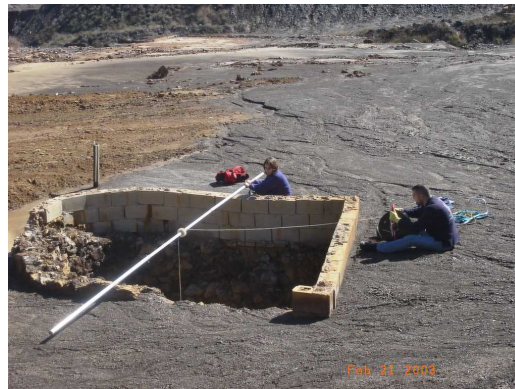
Figura 3.2 Imagen del momento de medida del nivel piezométrico en un pozo minero
