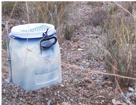
Figura 3.1 Bidón instalado en la superficie del terreno para la recogida de la deposición total atmosférica. A la derecha un esquema del dispositivo empleado modificado de Alcalá (2005)
