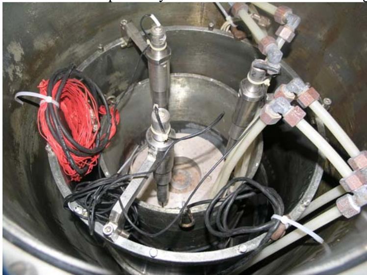
Figura. 3.3 LVDTs colocados sobre el cabezal y la célula de carga de 890 kN del equipo triaxial
