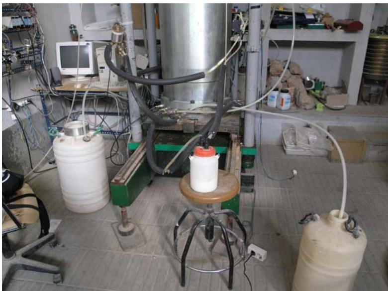
**Figura. 3.5 Recipiente con solución salina para la imposición de la humedad relativa, así como el higrometro para su medición. Panel de control de los transductores de señal y equipo de adquisición de datos**
