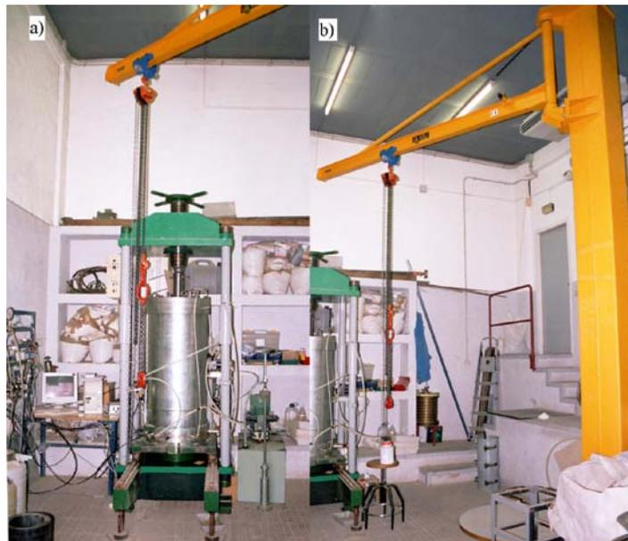
Figura. 3.1 Equipo triaxial para materiales granulares gruesos con control de HR
