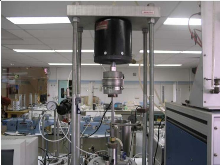
**Figura. 3.11** Bellofram para aplicar tensiones desviadoras estáticas y cíclicas y célula de carga para el equipo triaxial cíclico
