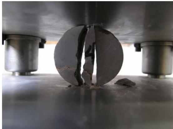
Figura. 4.5 Resistencia a la tracción mediante ensayo brasileño del material calizo.
