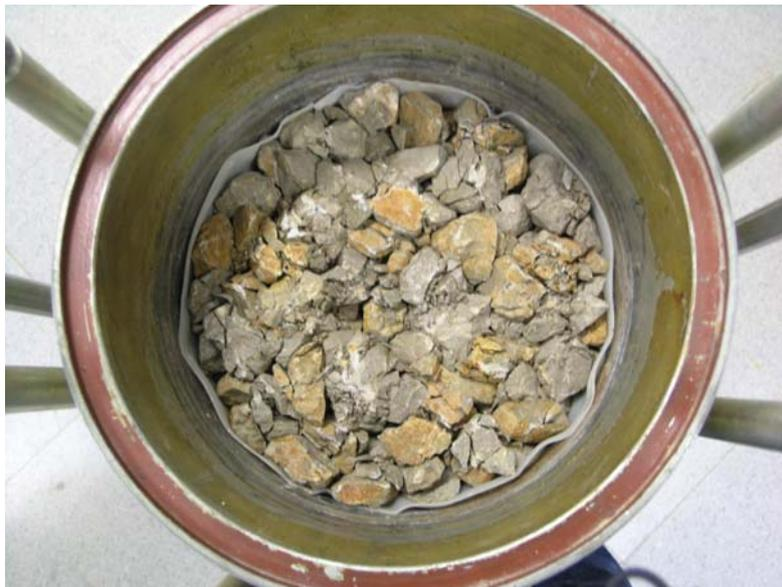
**Figura. 3.8** Rotura de material granular de tamaño medio de 30mm, después de haber sido sometido a trayectorias de tensión y succión. La muestra fue inundada a una tensión máxima de 2.8 MPa. Entre el anillo y la muestra existe un recubrimiento de látex con la finalidad de reducir la fricción entre el material granular y el anillo edométrico
