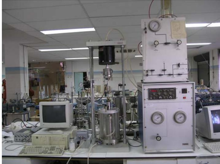
**Figura. 3.10** Equipo triaxial cíclico con control de HR
