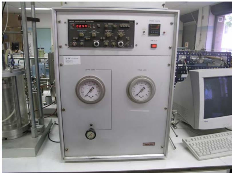
**Figura. 3.12** Generador de funciones para diferentes funciones de ondas, contador de ciclos y manómetros del equipo triaxial cíclico
