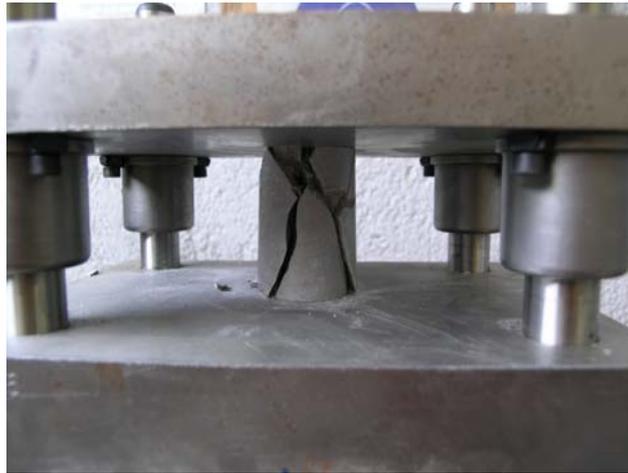
**Figura. 4.3 Resistencia a la compresión simple del material calizo entre dos placas paralelas colocadas en una prensa de 300 kN de capacidad**
