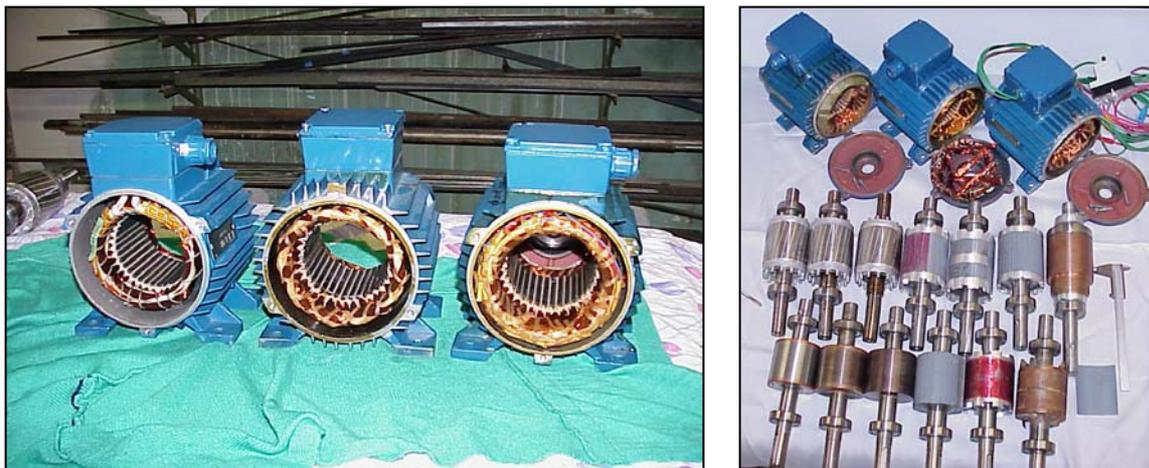
Figura 3.1. a) Vista de los tres rotores una vez rebobinados. b) Motores y rotores contruidos.
