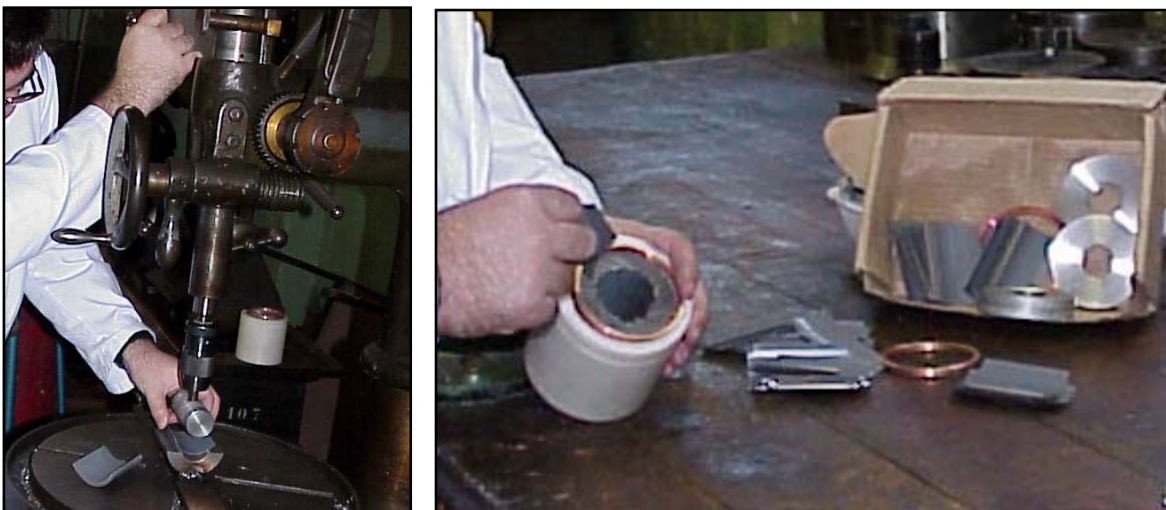
Figura 3.13. Rotor de chapas. Doblado y agrupación de las chapas en el molde del rotor.
