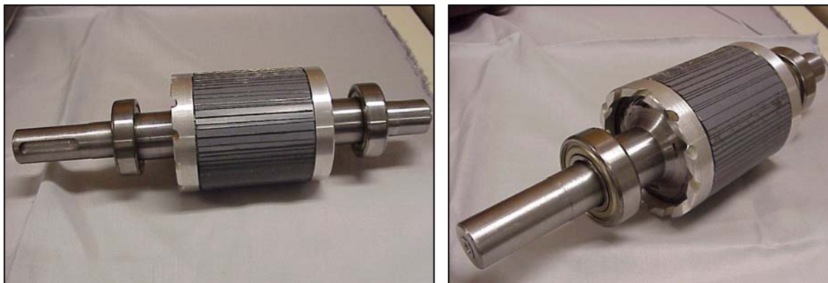
Figura 3.56. Rotor de chapas prototipo II. Vistas generales. Obsérvese en las figuras que el rotor se probó con diferentes aros
