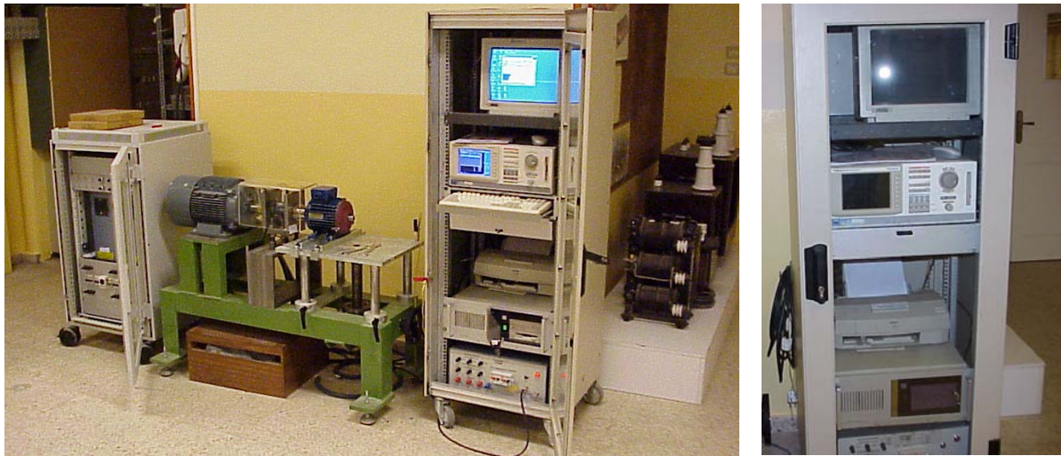
Figura 4.33. Equipo completo de pruebas. Detalle del analizador de potencia PZ4000, YOKAGAMA.
