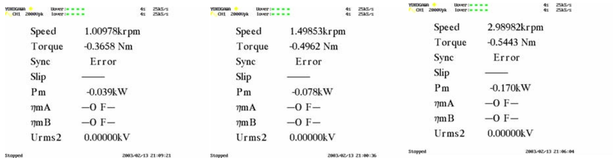
Figura 4.36. Ejemplo de la presentación de resultados para la determinación de las pérdidas mecánicas debidas al conjunto cojinete-ventilador-aire-rotor para el rotor de chapas tipo B en sus tres regímenes.
