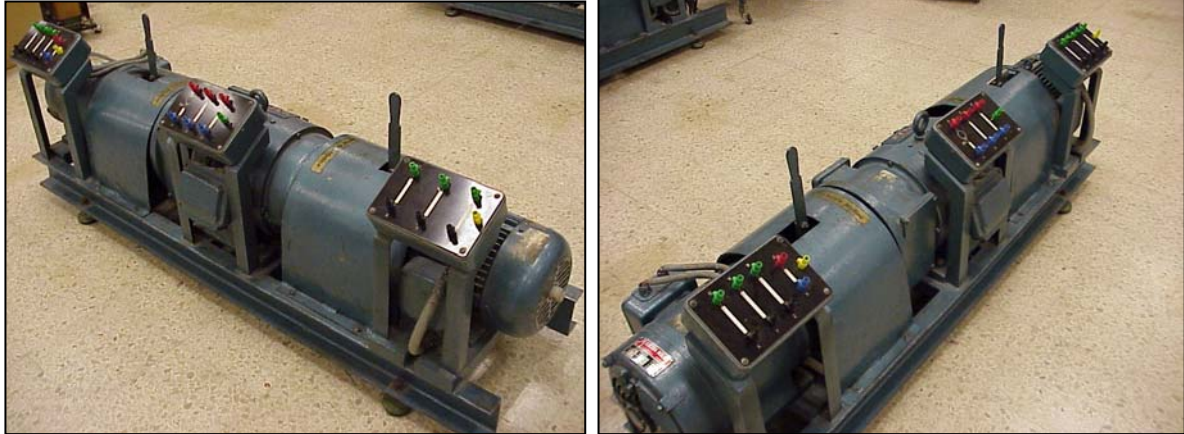
Figura 4.2. Conjunto motor-alternador-dinamo. Pueden apreciarse las cajas de bornes y las palancas de desconexión.
