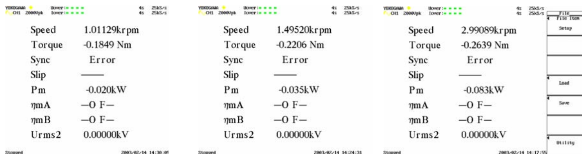
Figura 4.34. Ejemplo de la presentación de resultados para la determinación de las pérdidas mecánicas del cojinete de la bancada de pruebas en sus tres regímenes (1000, 1500 y 3000 rpm).
