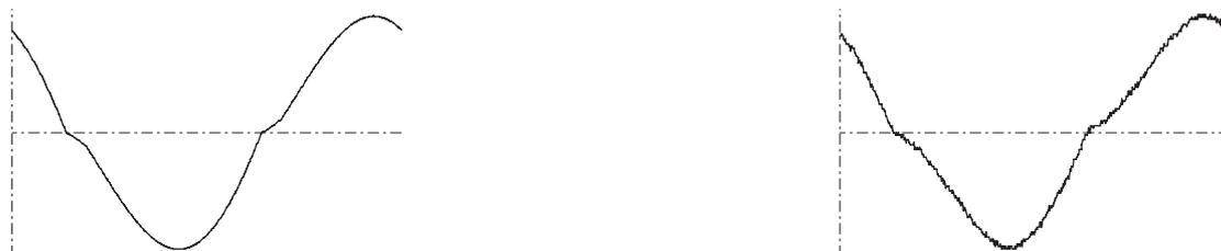
Luego se tomó una lámpara de vapor de sodio de alta presión de 220 V, 50 Hz y 70 W y se midieron los valores:  $R = 29 \Omega$ ,  $L = 0.63 \text{ H}$ ,  $U_E = 90 \text{ V}$ ,  $U_P = 160 \text{ V}$  y  $\Delta = 1.18 \text{ ms}$ . A partir de esta lámpara se estudiaron los casos que se presentan en la tabla siguiente.
