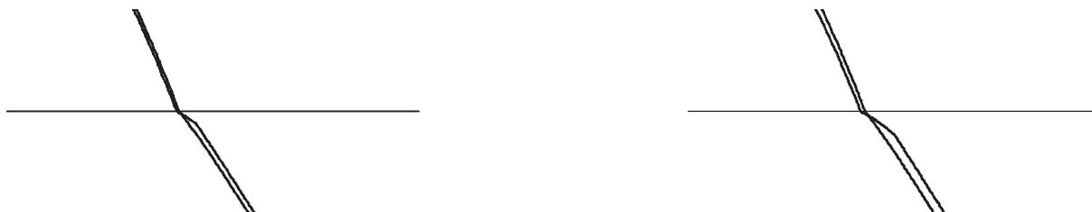
La gráfica siguiente presenta las formas de onda obtenidas para los casos 2, 3 y 4. Se observa que al aumentar el ancho del pulso disminuye la pendiente después del paso por cero.
