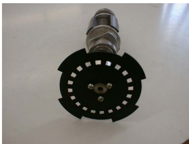
Detalle del disco para el captador de posición.
