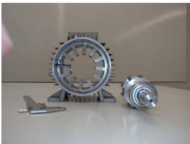
Detalle del estator y del rotor.
