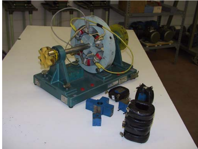
Piezas y bobinas para el montaje.
