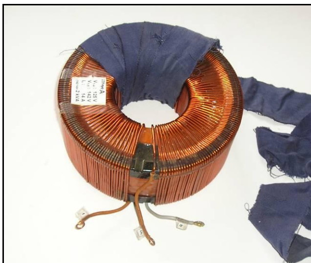
Figura. 3-11. Torus magnètic A del varivolt trifàsic utilitzat per fer el prototip.
