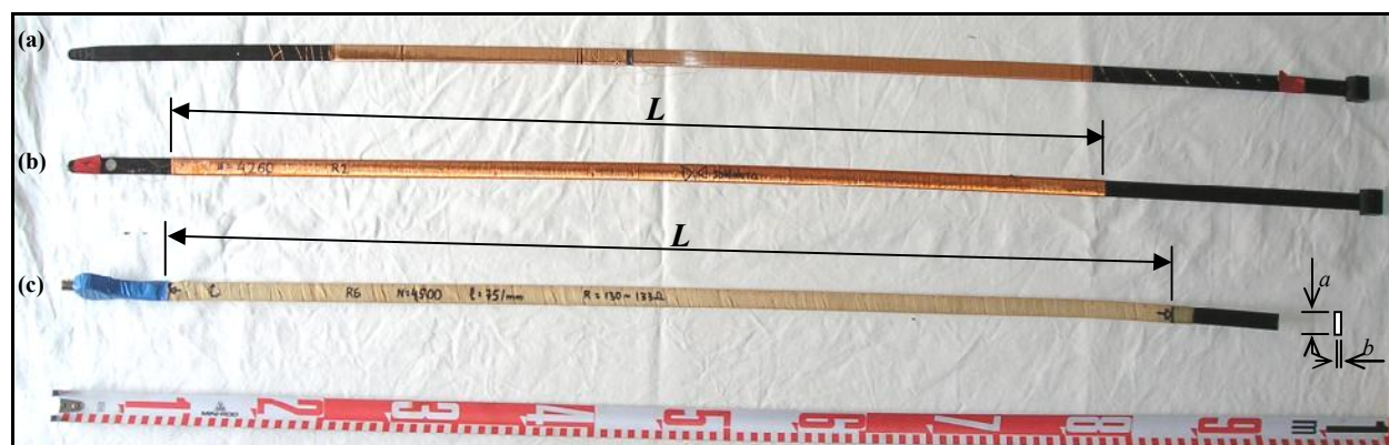
Figura A-5. Bobines en diferents moments de construcció: (a) bobina de capa simple; (b) bobina de doble capa després d'esmltar; (c) BR6, amb recobriment de cotó i vernís, text identificatiu i BNC.
