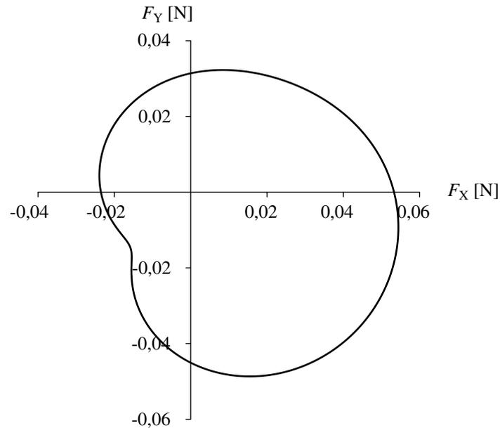
Figura A.2.4 Variación polar de la fuerza de inercia total del mecanismo
