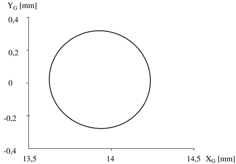
Figura A.2.3 Trayectoria del centro de masas de los eslabones móviles del cuadrilátero articulado
