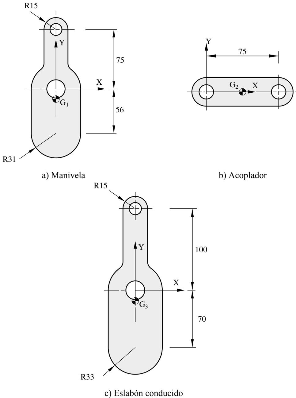
Figura A.2.2 Diseño de los eslabones del mecanismo de doble manivela
