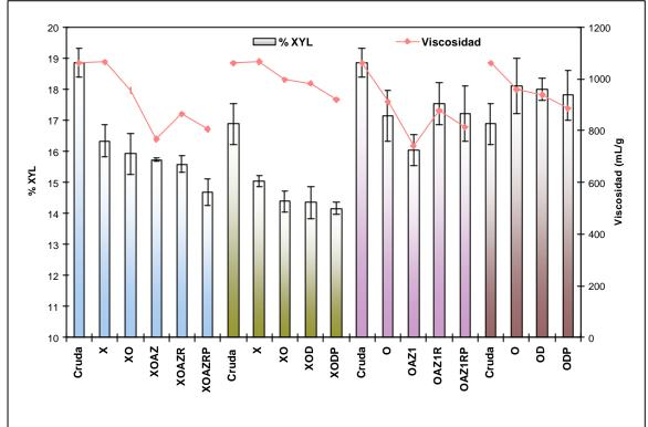
**Figura 10-11.** Porcentajes de xilosa y valores de viscosidad de las secuencias TCF XOAZRP y OAZ<sub>1</sub>RP, y las secuencias ECF XODP y ODP.
