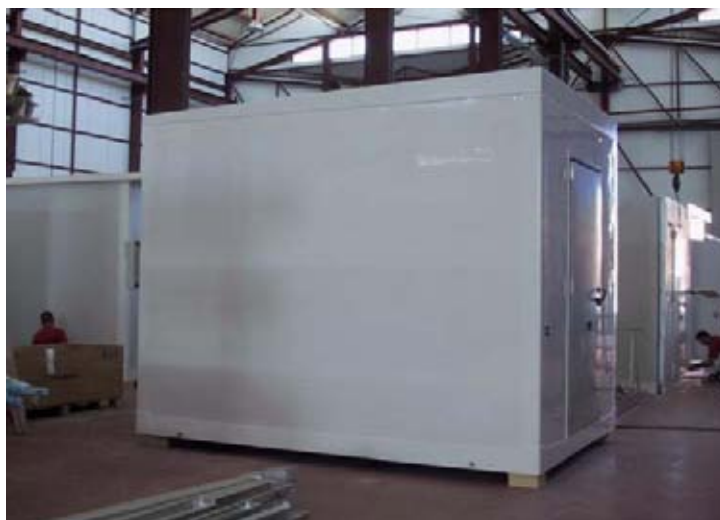
Imatge 71. Primer prototipus de caseta prefabricada de xapa de fibra de vidre Model Barcelona, a l'interior de la fàbrica de l'empresa Shelcom. Fotografia de Xavier Alonso. 9/11/2001 154 .
