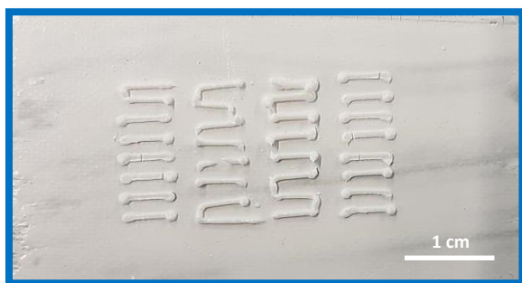
Figura 5.10 Impresión 3D en forma de línea discontinua de nanotitanio en 3D sobre capa de puente de adherencia acrílico en fresco y soporte de mortero de cemento, tras tratamiento térmico a 150°C durante 2 horas.
