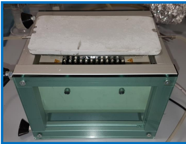
Figura 5.5 Colocación de los reactores durante el estudio de la actividad fotocatalítica.
