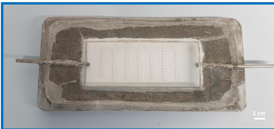
Figura 5.13 Reactor de mortero con impresión 3D de titania en línea discontinua.
