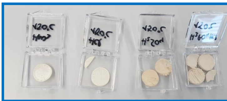
Figura 4.9 Láminas impresas en 3D con diferentes ácidos y tratados térmicamente a 150°C para el análisis de absorción UV-Vis. De izquierda a derecha, HNO 3 , HCl, H 2 SO 4 y H 3 PO 4 -HCl respectivamente.
