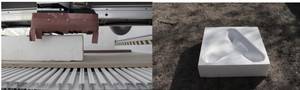
Figura 7: Fabricación digital del molde. (foto del autor)
