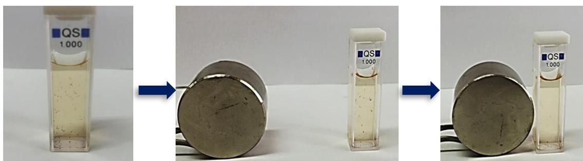
**Fig. 3.3.** Nanofibras NFm(S3+BKF) en presencia de un campo magnético externo.
