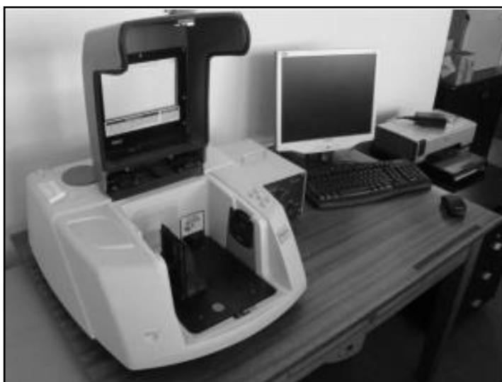
Figure II.10 : Schéma d'un spectromètre à transformée de Fourier
