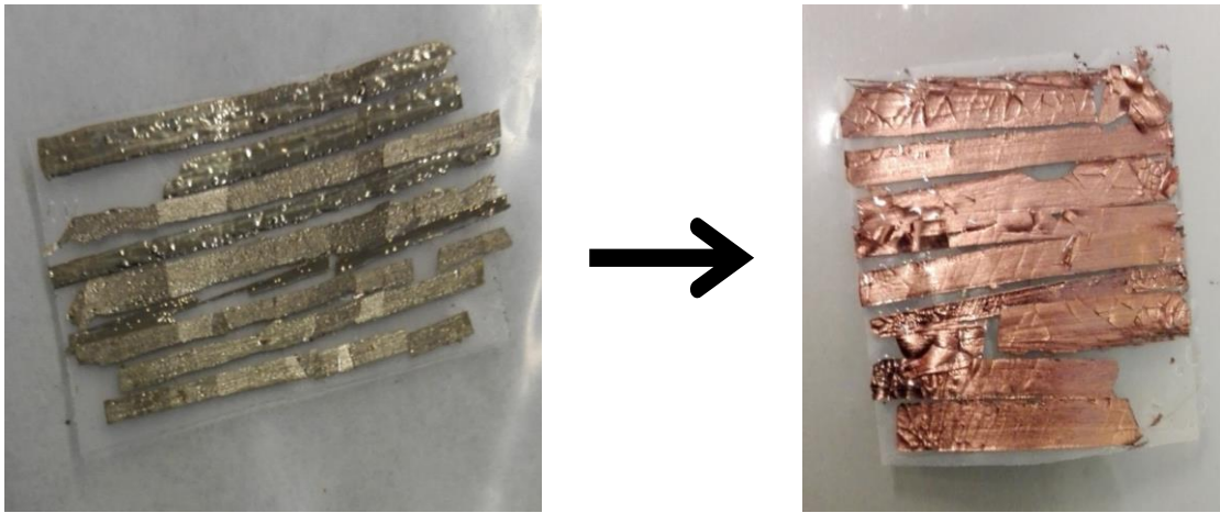
Figure VI.3 : Image de l'aspect externe des rubans Cu-Mg-Ca avant et après le processus de dealloying.
