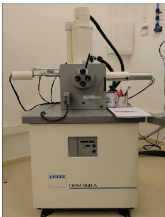
Figure II.5: Microscopie électronique à balayage utilisé, type ZEISS DSM 960A.
