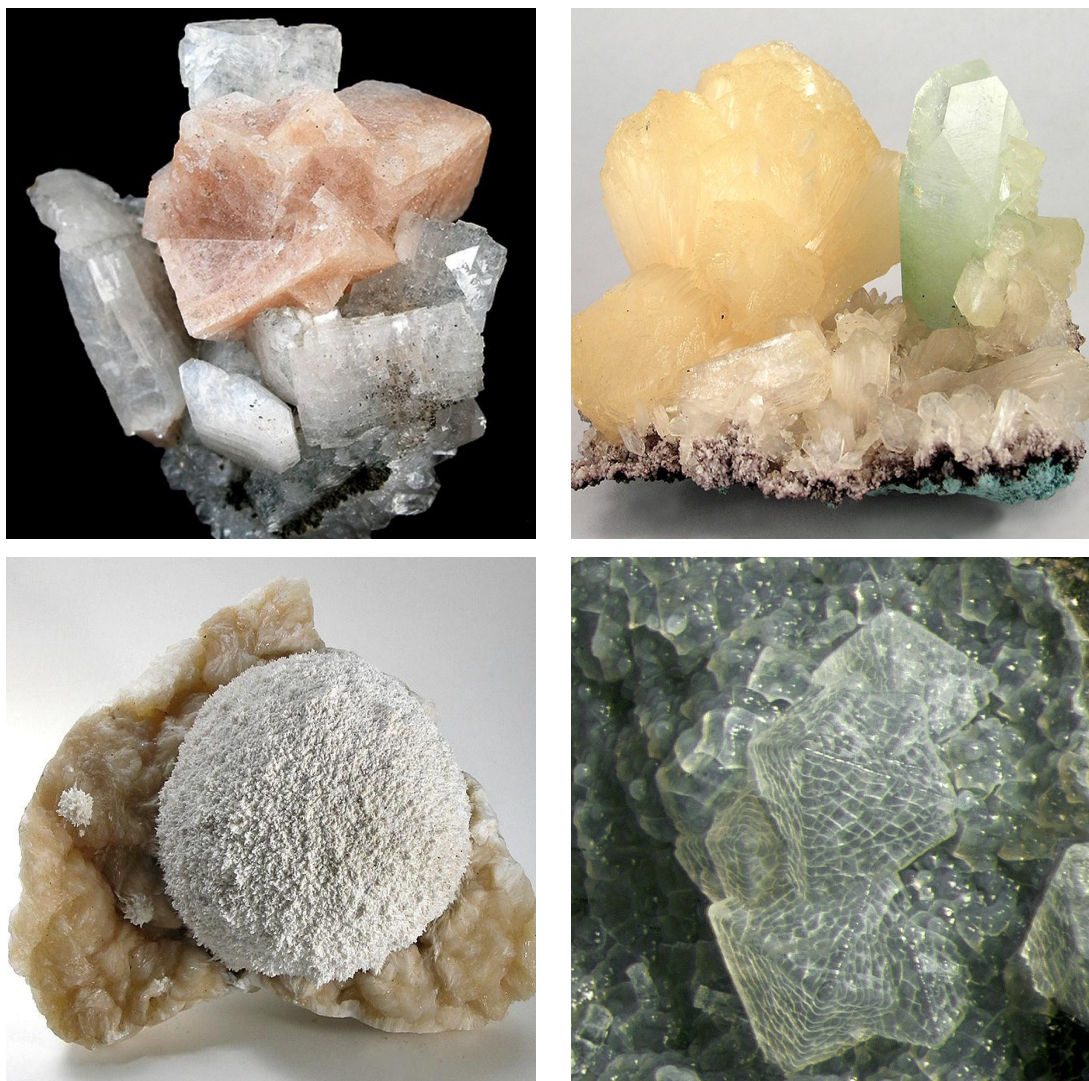
Fig. 10.1. Imatges de quatre zeolites naturals. Chabazita 3 (dalt esquerra), estilbita 4 (dalt dreta), mordenita 5 (baix esquerra) i faujasita 6 (baix dreta).
