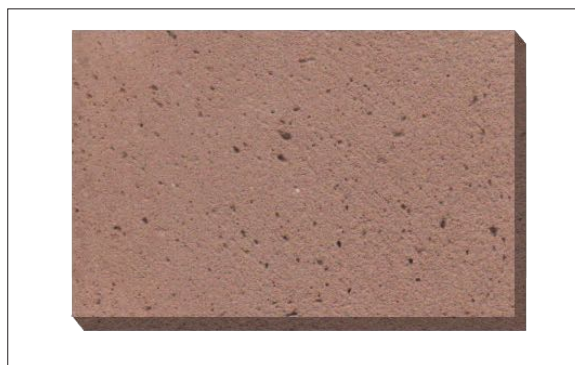
Fig. 6.12.4.2 Fotografía de la muestra GEO-D103 en la que se observan los macro poros del polímero a base de arcilla Tipo A.
