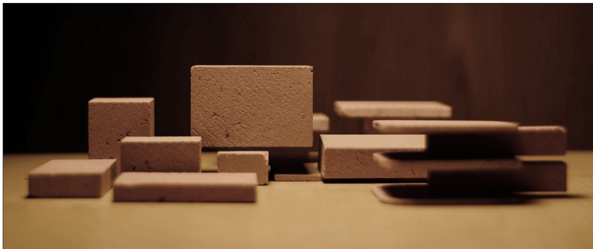
Fig. 7.2 Fotografía de bloques y placas de arcilla polimerizada Tipo A fabricadas en la campaña experimental en el Laboratorio de materiales de la Escola Politècnica Superior d'Edificació de Barcelona (EPSEB).
