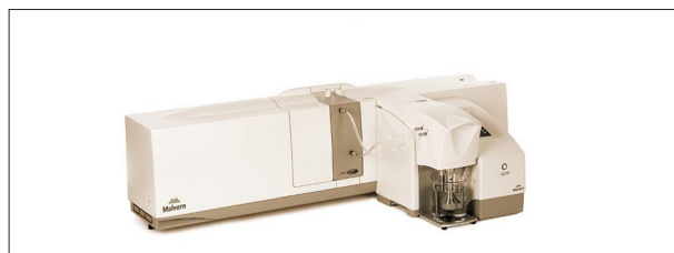
Fig. 6.4.4 Equipo de análisis de la distribución de tamaños de partículas mediante difracción láser Mastersizer 2000 Malvern PANalytical.
