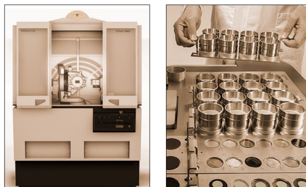
Fig. 6.4.1 (derecha) Equipo de Análisis por difracción de rayos X (PANalytical X'Pert PRO MRD diffractometer). Fig. 6.4.2 (izquierda) Equipo de análisis por fluorescencia de rayos X (Panalytical, Axios PW 4400/40 sequential wavelength - dispersive X-ray spectrophotometer (WDXRF)).
