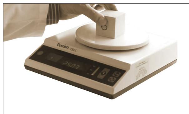
Fig. 6.4.8 Determinación de la porosidad y la densidad según las instrucciones establecidas en las norma correspondientes.
