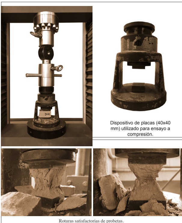
Fig. 6.4.15 Imágenes de ensayo a compresión.
