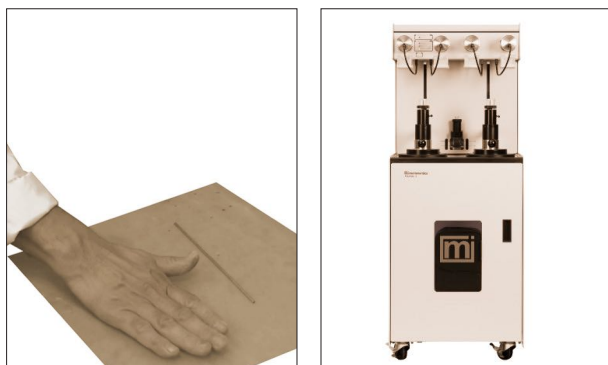
Fig. 6.4.7 Izquierda: determinación del límite plástico de arcillas conforme a la norma UNE 103104:1993. Derecha: equipo AutoPore V Series Mercury Porosimeters para análisis de porosimetría por inyección de mercurio.
