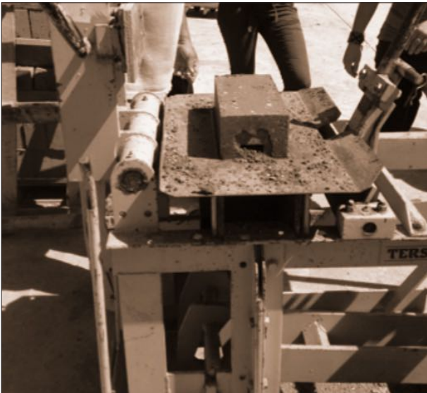
Fig. 2.3.2a Los bloques convencionales de tierra compactados (BTC) alcanzan una resistencia a la compresión que oscila entre 2 y 6,5 MPa dependiendo el tipo de estabilización y el porcentaje de aditivo utilizado. Esta resistencia es baja comparada con la resistencia del hormigón o los ladrillos cerámicos (mayores a 20MPa).
