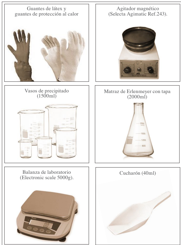
Fig. 6.8.1.1 Equipo necesario para la preparación del activador alcalino.
