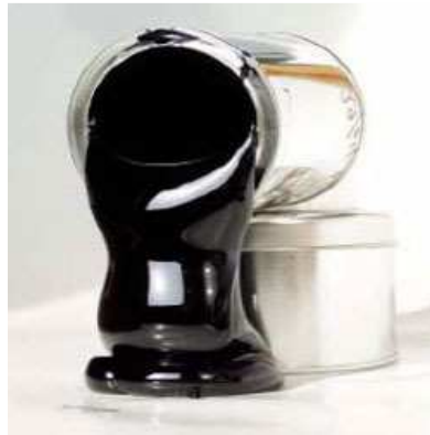
Figura 1: Ejemplo de ligante hidrocarbonado básico.
