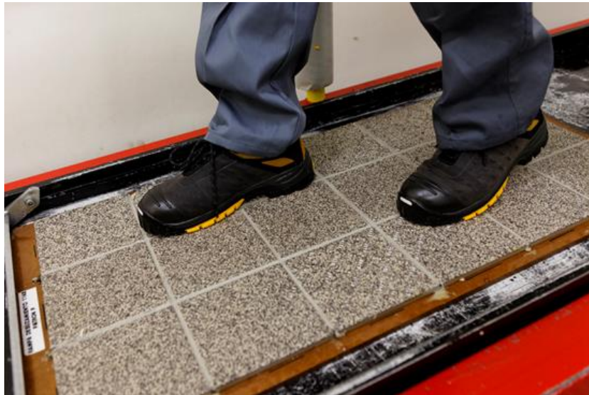
Figura 3.12 Ensayo rampa pie calzado.
