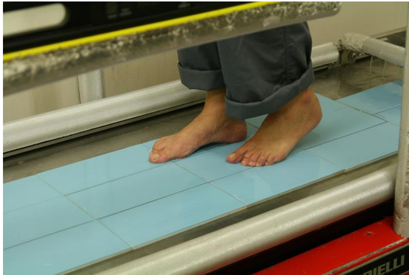
Figura 3.15 Ensayo rampa pie descalzo.
