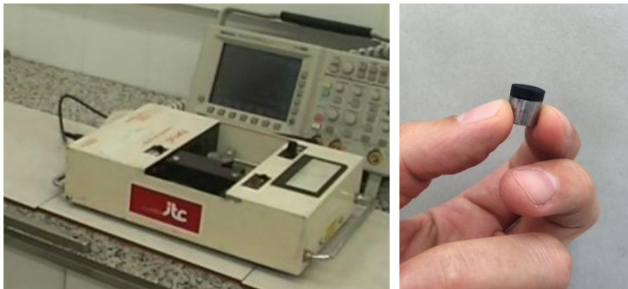
Figura 1.12 Equipo Tortus® empleado para medir el coeficiente de fricción dinámico en pavimentos cerámicos y detalle del deslizador.
