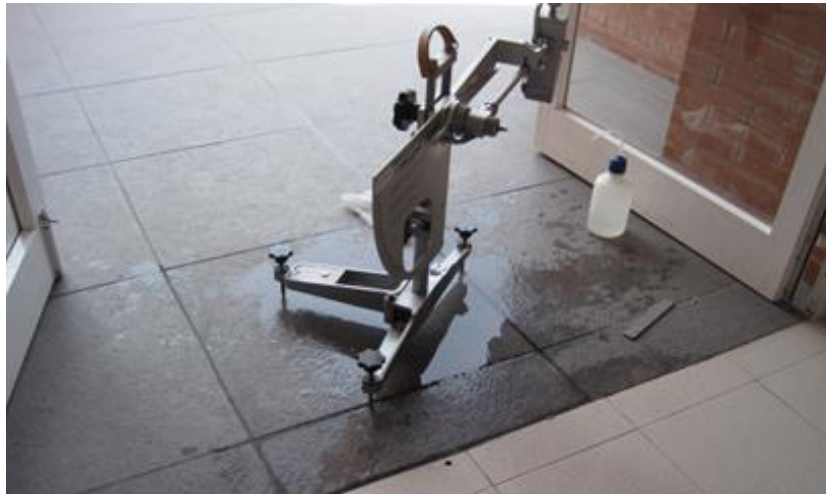
Figura 3.22 Medida sobre la baldosa de seguimiento colocada en el centro del acceso.
