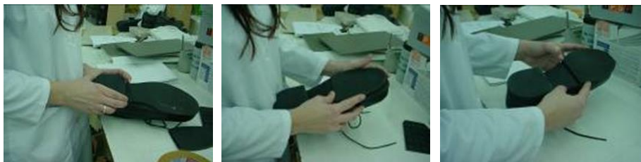
Figura 3.8 Colocación de pieza de tacón y pieza delantera a modo de suela. Variante de diseño lisa.
