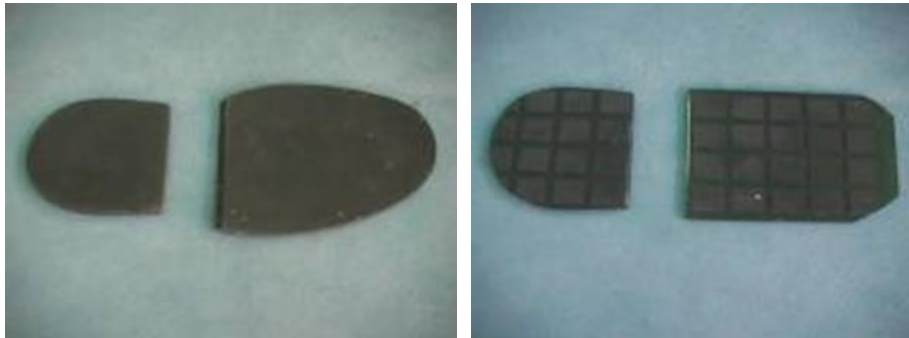
Figura 3.7 Ejemplos de piezas de media suela y tacón para fijar como suela del zapato de referencia.
