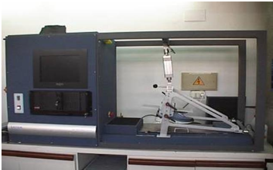
Figura 1.14 Equipo normalizado empleado para medir el coeficiente de fricción dinámico de suelas de calzado ( EN-ISO 13287 ).
