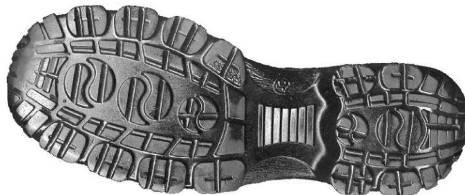
Figura 1.19 Suela del calzado normalizado utilizado en la norma DIN 51130.
