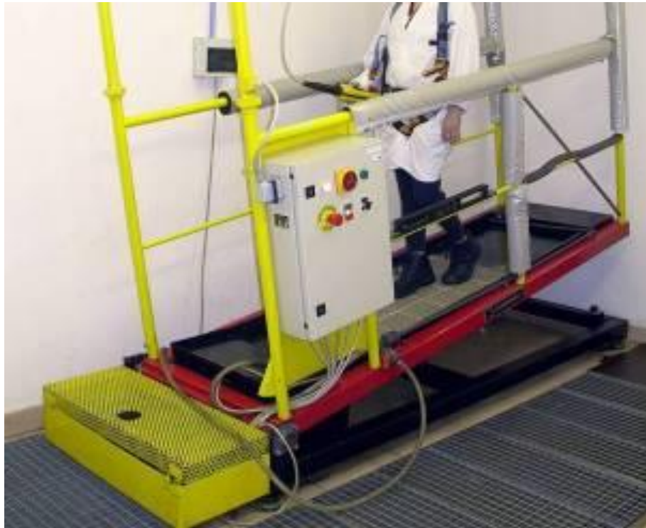
Figura 1.18 Equipo para realizar el ensayo de la rampa inclinada.
