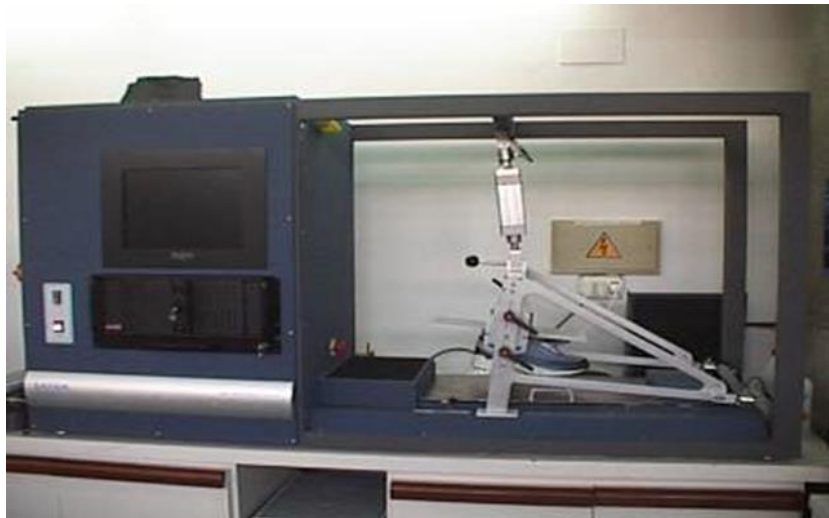
Figura 3.10 Equipo normalizado empleado para medir el coeficiente de fricción dinámico de suelas de calzado (EN-ISO 13287).
