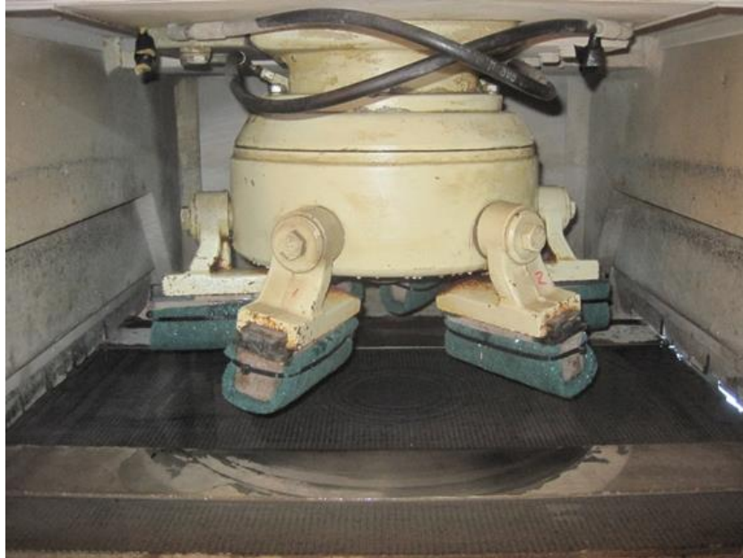
Figura 3.26 Portamuelas del cabezal de pulido.
