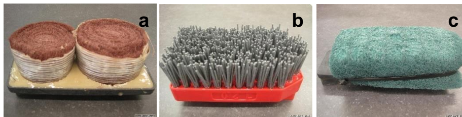
Figura 4.57 Materiales abrasivos utilizados: a) cepillo tipo lija, b) cepillo de SiC, c) estropajo comercial.
