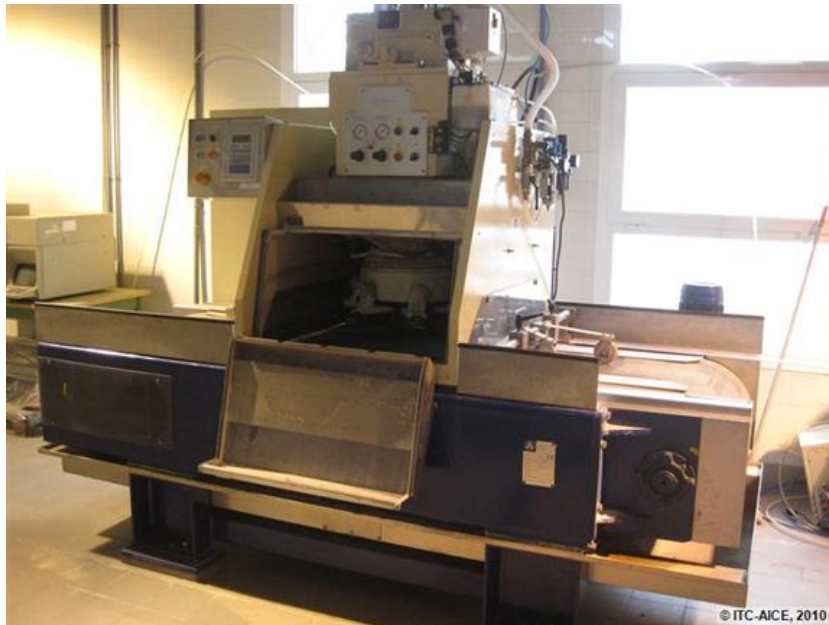
Figura 3.25 Cabezal de pulido utilizado para simular el desgaste en pavimentos.
