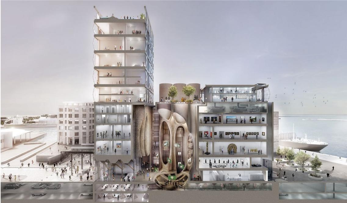
Fig. 5.53. Zeitz Museum, MOCAA. Infografía arquitectónica del proyecto donde se puede apreciar la excavación del atrio central en forma de “grano de maíz” como elemento central y generador del edificio. Ciudad del Cabo, Sudáfrica. Proyecto 2011-2017. Fuente: <http://www.heatherwick.com/projects/buildings/zeitz-mocaa/>
