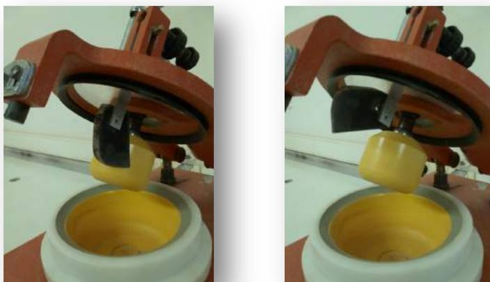
Figura 4.84 Posición de la cuchilla o espátula en el molino de mortero
