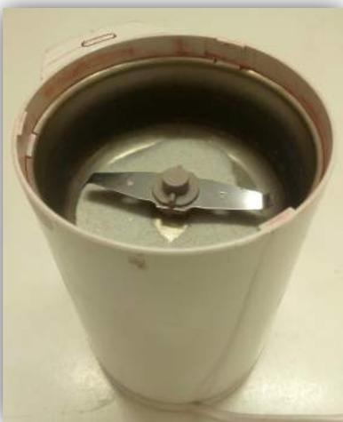
Figura 3.14 Molino de cuchillas
