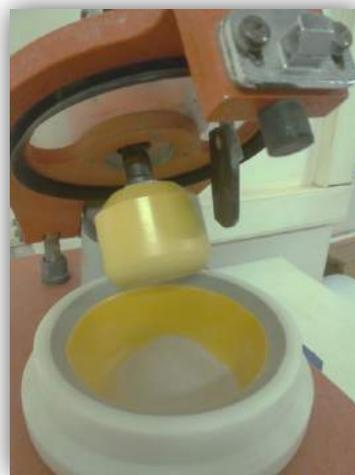
Figura 3.15 Molino de mortero
