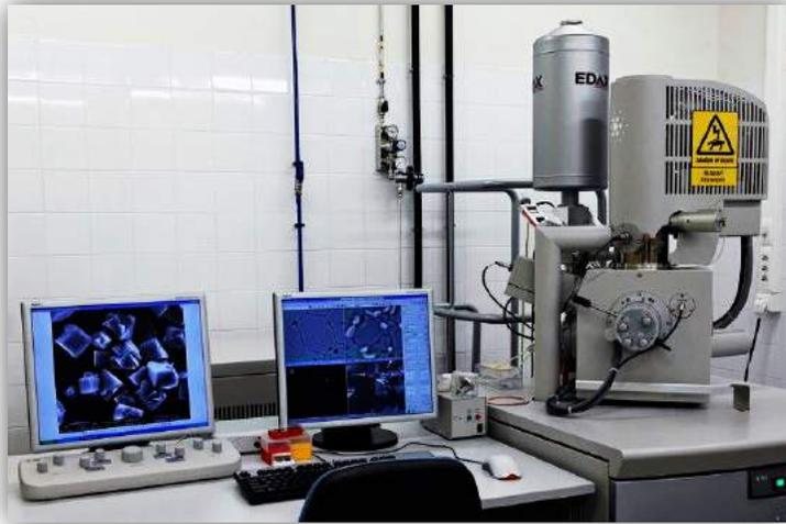
Figura 3.27 Microscopio electrónico de barrido FEG-ESEM QUANTA 200F
