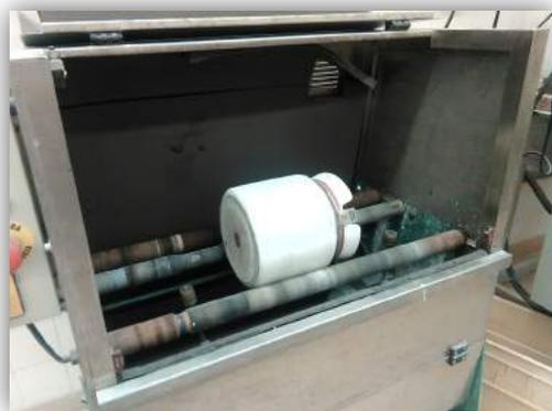
Figura 3.13 Molino horizontal de bastidores
