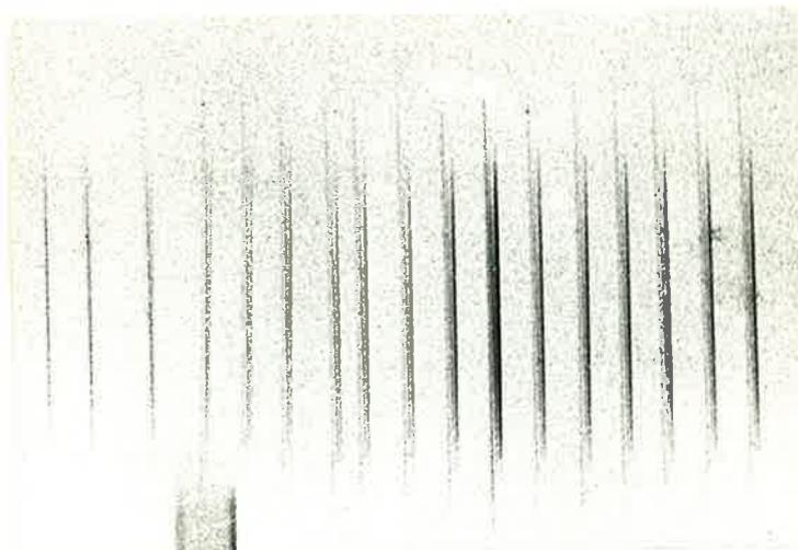
Fig. 70 Exploración en el foco del efecto del cierre gradual de la pantalla izquierda de la ventana de entrada.
