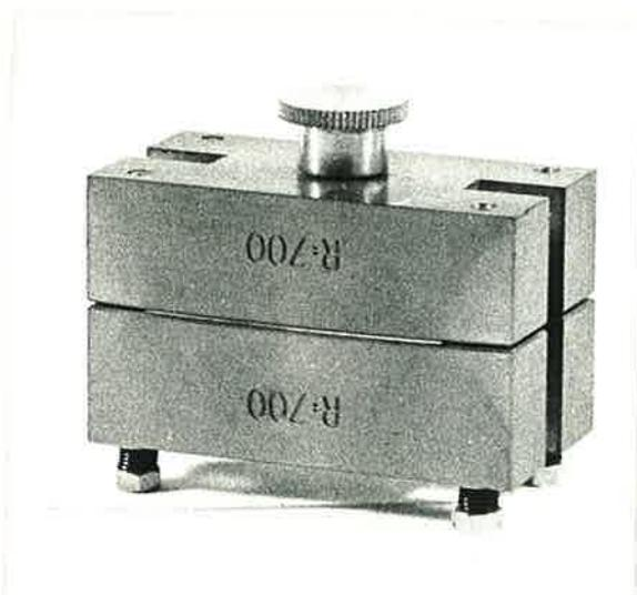
Fig. 75 Prensa de la lámina de cuarzo con el tornillo de antidifusión.
