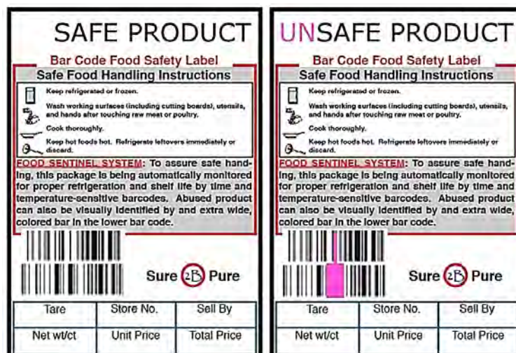
Figura 1.38. Ejemplo de sistema de envase inteligente Food Sentinel System desarrollado por la empresa SIRA Technologies para la determinación de bacterias patógenas en alimentos [213].
