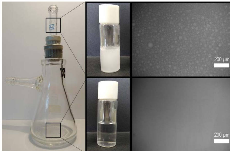
Figura 6.10. Separació de l'emulsió oli en aigua per filtració. La imatge superior mostra l'emulsió abans de la separació mentre que la inferior mostra la solució un cop filtrada i sense la presència d'oli.
