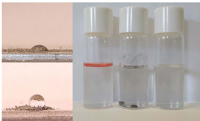
Figura 6.9. Separació de l'oli en aigua: (esquerra) sistema amb ambdues fases (l'oli de color vermell amb Oil Red O); (centre) separació de l'oli sobre la superfície del ferro funcionalitzat i formant la bala característica i (dreta) aigua sense la presència d'oli un cop s'ha decantat.
