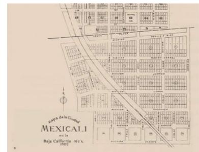
**Figura 69.** En el plano de 1902 se aprecia la frontera en línea horizontal y en línea vertical poco curvada la línea de ferrocarril. Las trazas coinciden con algunas calles, la lotificación cuadrícula y más dividida en Estados Unidos y rectangular y un poco menos dividida en México. Fuente: Libro "Ciudades mexicanas del siglo XX" de Héctor Quiroz Rothe, editado por UNAM.
