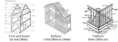
**Figura 82.** Esta tipología constructiva produce edificios (normalmente viviendas de una o dos plantas) más ligeros y fáciles de construir. Fuente: <http://www.newmainetimes.org/>
