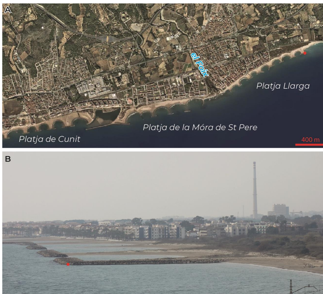
Figura 35. Espigons paral·lels a la costa. A – Sector entre Vilanova i la Geltrú i Cunit; B – Platja Llargà de Vilanova i la Geltrú i Cubelles. En vermell s'ha marcat el punt en comú de les dues fotografies.
