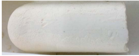
Figura 3.23 Crisol de SrCeZrYb sinterizado a 1200 °C.
