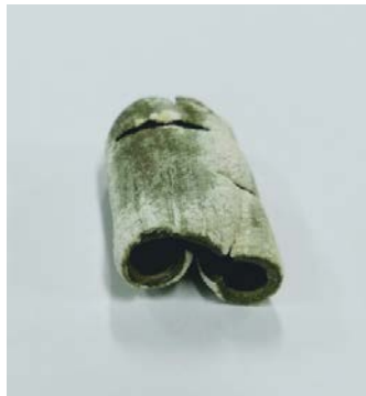
Figura 3.21 Crisol de SrCeZrYb sinterizado a 1400 °C.
