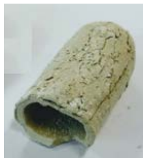
Figura 3.22 Crisol de SrCeZrYb sinterizado a 1300 °C.
