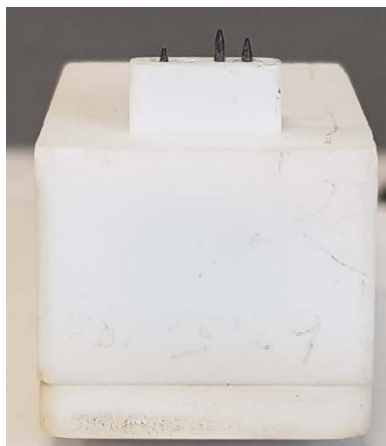
Figura 3.31. Dispositivo comercial de medida de conductividad después de realizar ensayos a alta temperatura.
