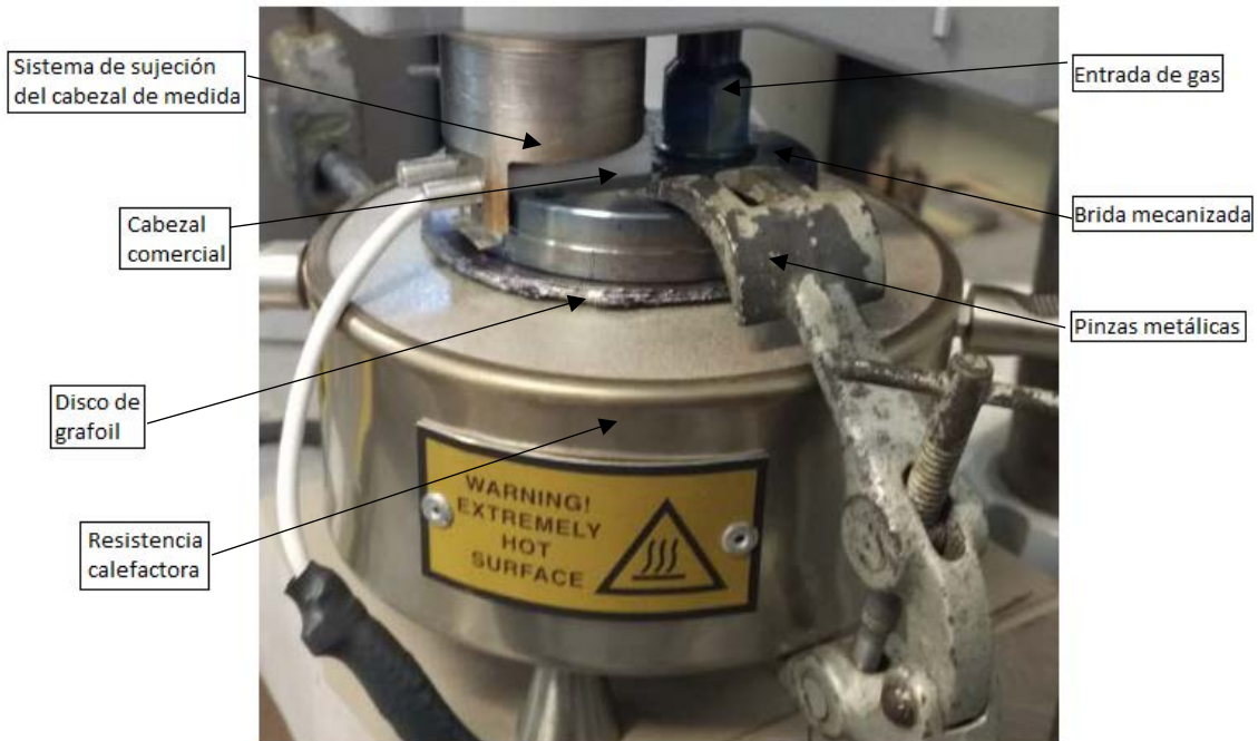
Figura 3.29 Sistema de confinamiento diseñado.
