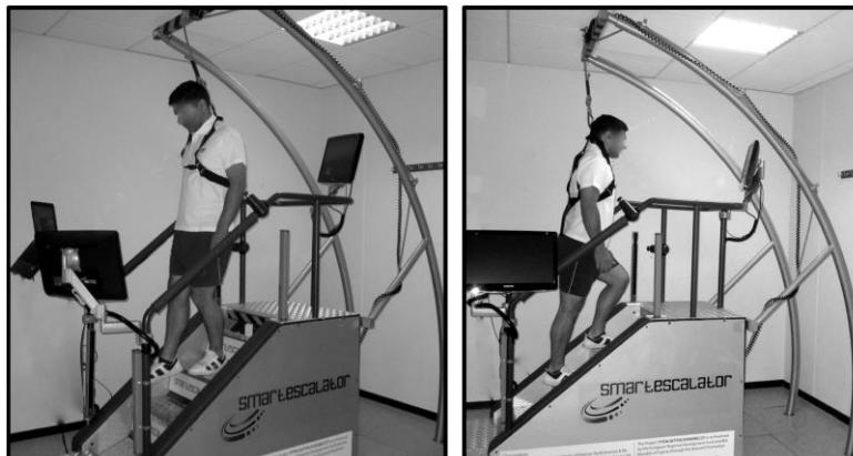
Figura 2-28. Dispositivo de escalera mecánica que permite el ascenso (acción concéntrica) y descenso (acción excéntrica) [132].
