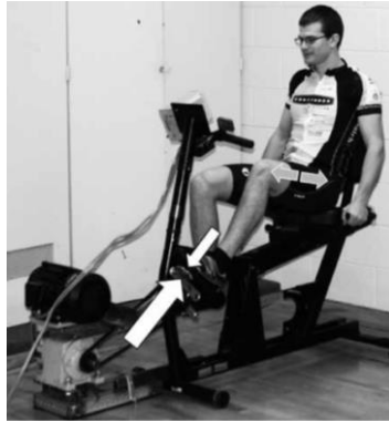
Figura 2-10. Cicloergómetro excéntrico. A medida que los pedales se mueven hacia el individuo (flecha blanca grande), el individuo resiste el movimiento mediante la aplicación de fuerza a los pedales (pequeña flecha blanca). Puesto que la magnitud de la fuerza producida por el motor excede la producida por el individuo, los extensores de la pierna (flechas grises en el muslo) se alargan de forma activa (acción muscular excéntrica) [112].
