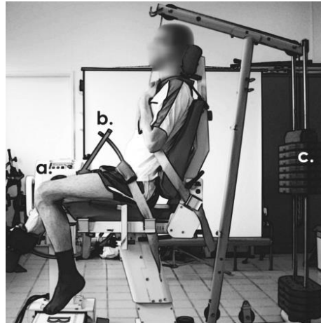
Figura 2-17. Dispositivo de entrenamiento de fuerza integrado junto a un dinamómetro isocinético Biodex System 3 a), las cargas (c) estaban vinculadas al dinamómetro mediante un cable. El cable pasa a través de dos poleas y acompañaba una pieza de metal semicircular (b) fijada al dinamómetro. [120].
