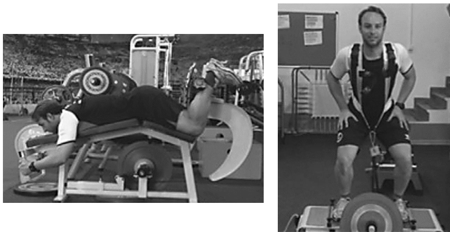
Figura 2-22. Dispositivo YoYo™ para realizar el ejercicio leg-curl y la media sentadilla (izquierda) [125].
