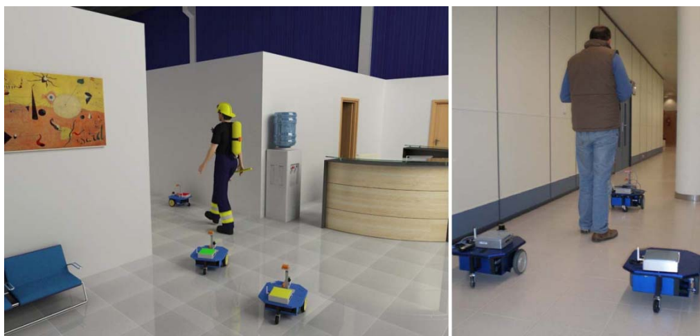
Figura 30. Idea principal del proyecto GUARDIANS. La imagen de la izquierda corresponde a una recreación en 3D donde un enjambre de robots colabora con un bombero en tareas de búsqueda y rescate. La imagen de la derecha pertenece a un experimento real llevado a cabo en los pasillos del edificio TI de la UJI
