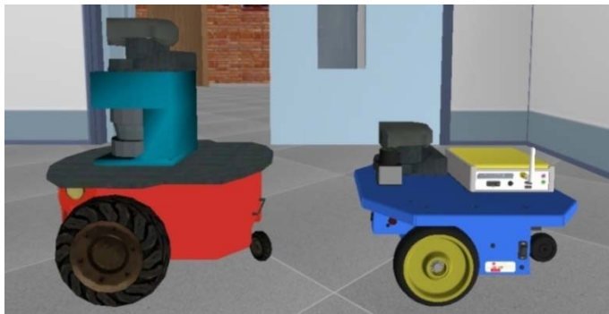
Figura 34. Modelos 3D para la simulación de los robots P2DX (izquierda) y Erratic (derecha)
