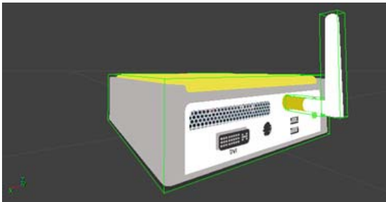
Figura 41. Ordenador del robot Erratic con sus envolventes de colisión marcadas aristas verdes
