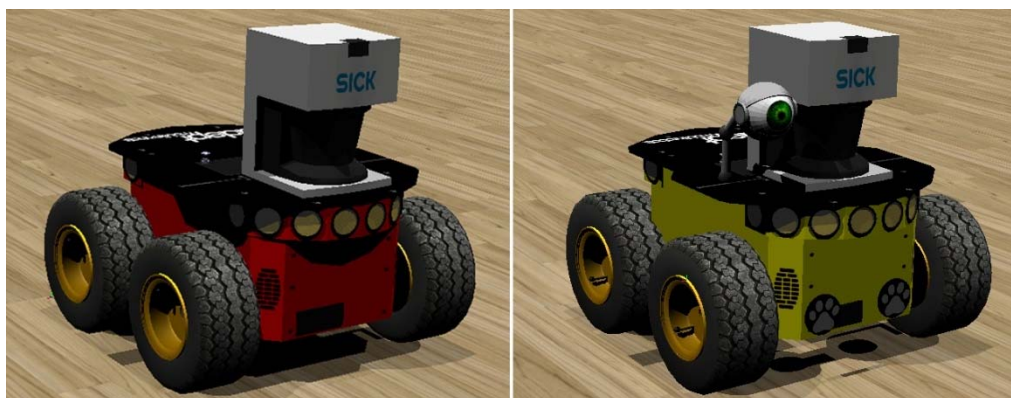
Figura 108. A la izquierda se muestra un modelo de robot Pioneer 3AT incluido en Webots. A la derecha está el modelo modificado con cámara y sensores para detectar presencia de suelo
