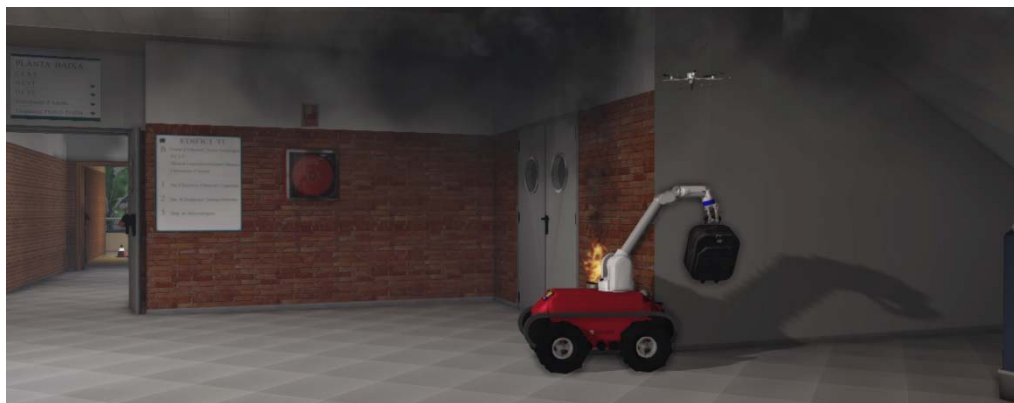
Figura 137. Combinación de movimientos animados y simulados en una secuencia de detección y agarre. El robot terrestre cuenta con un brazo con el que toma una maleta olvidada en el suelo
