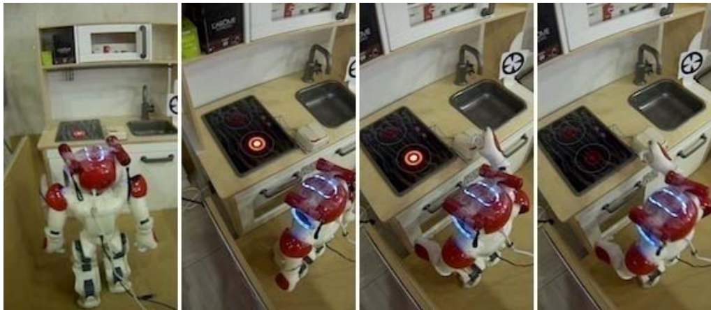
Figura 154. Secuencia de instantáneas correspondientes a la primera prueba ejecutada por el equipo de la Universidad Politécnica de Cataluña. El robot NAO identifica el fogón encendido y lo apaga accionando el pulsador pertinente
