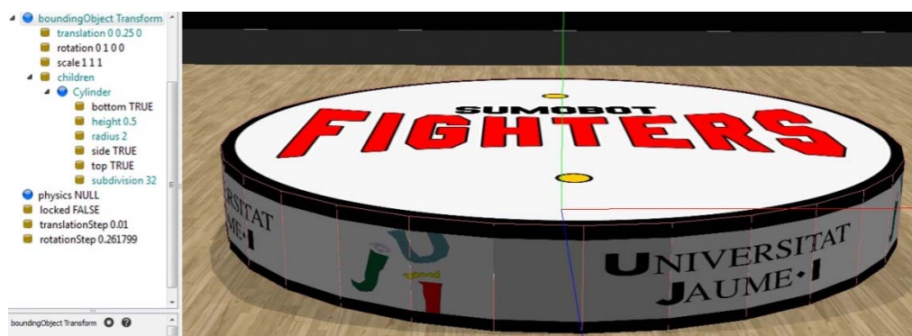
Figura 107. Contorno de colisión del ring de sumo representado por un cilindro con aristas en rosa
