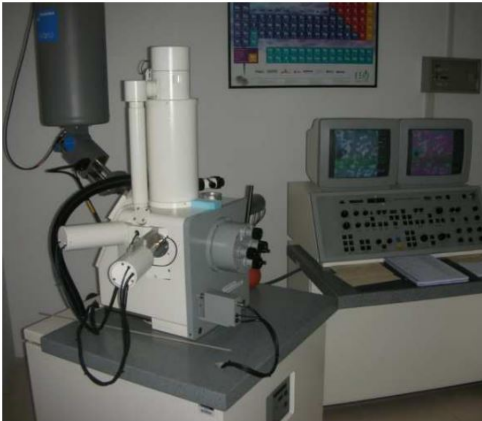
Figura 2.11: Equip de microscòpia electrònica de rastreig. A la part de davant es pot observar la columna d'acceleració d'electrons.
