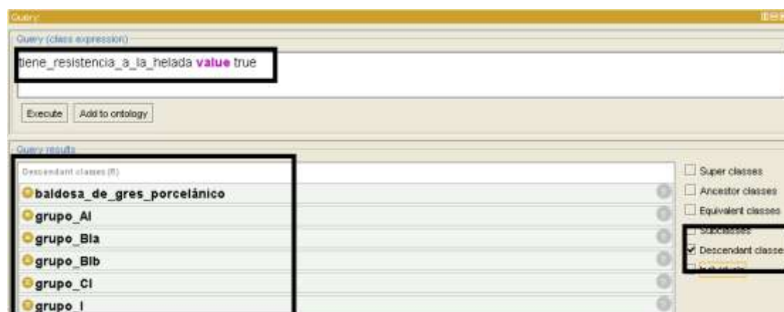
Figura 184. Resultado de la consulta sobre baldosas con resistencia a la helada
