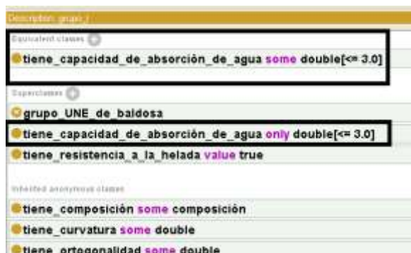
Figura 167. Clase de baldosa cerámica con característica distintiva ‘tiene capacidad de absorción de agua’
